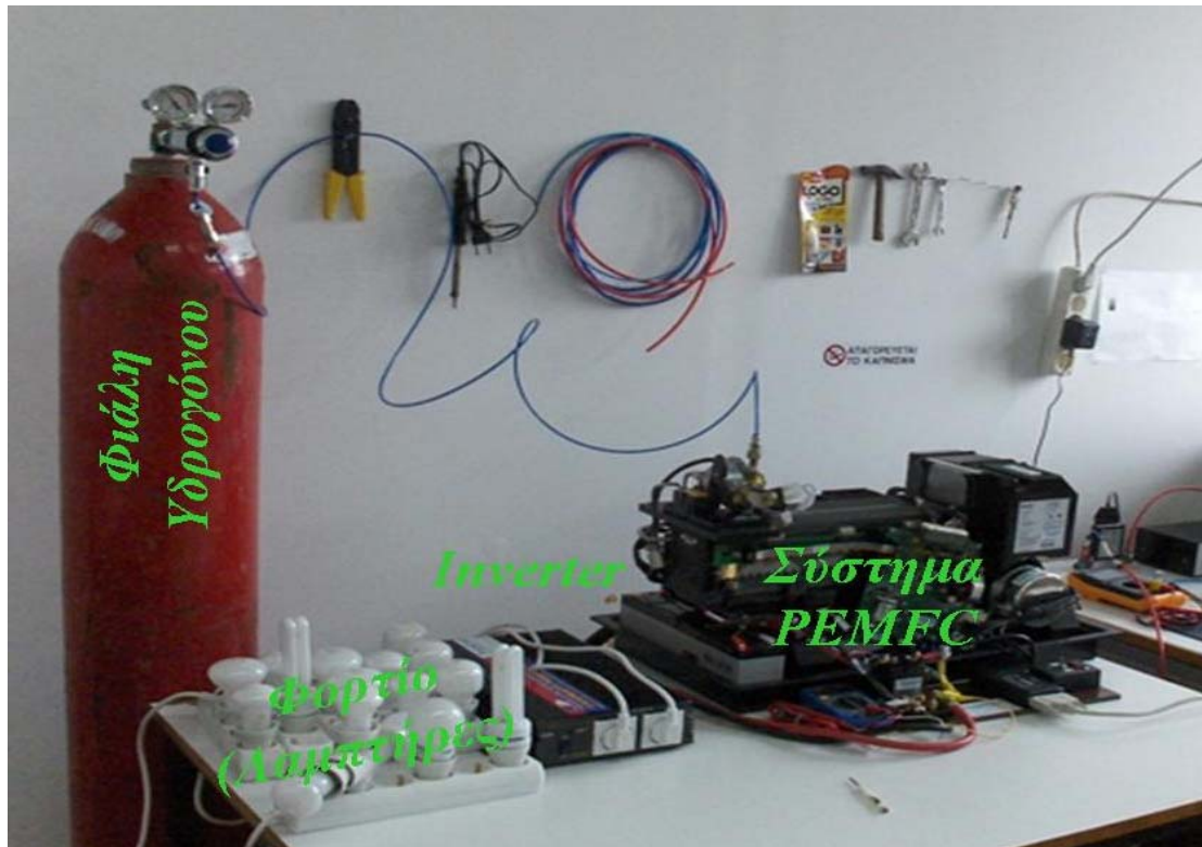
Σχήμα 7.5: Πειραματική διάταξη του συστήματος κελιών καυσίμου Nexa™ power module
