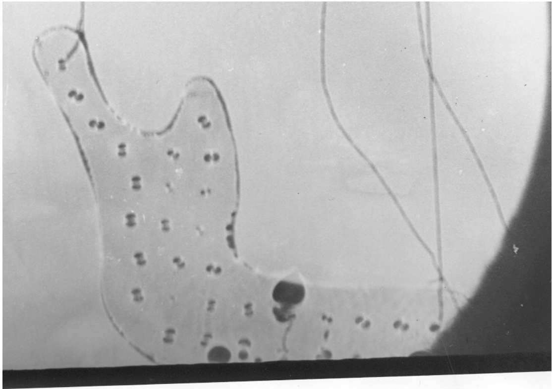
Σχήμα 4.20 Στιγμιότυπο διάδοσης του τασικού παλμού για το δοκίμιο στα 136 \mu\text{sec}
