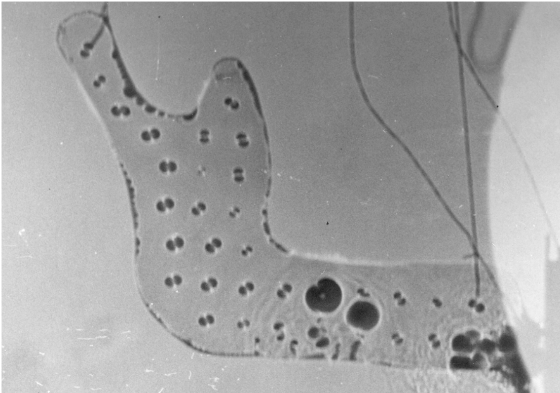
Σχήμα 4.18 Στιγμιότυπο διάδοσης του τασικού παλμού για το δοκίμιο στα 120 \mu\text{sec}
