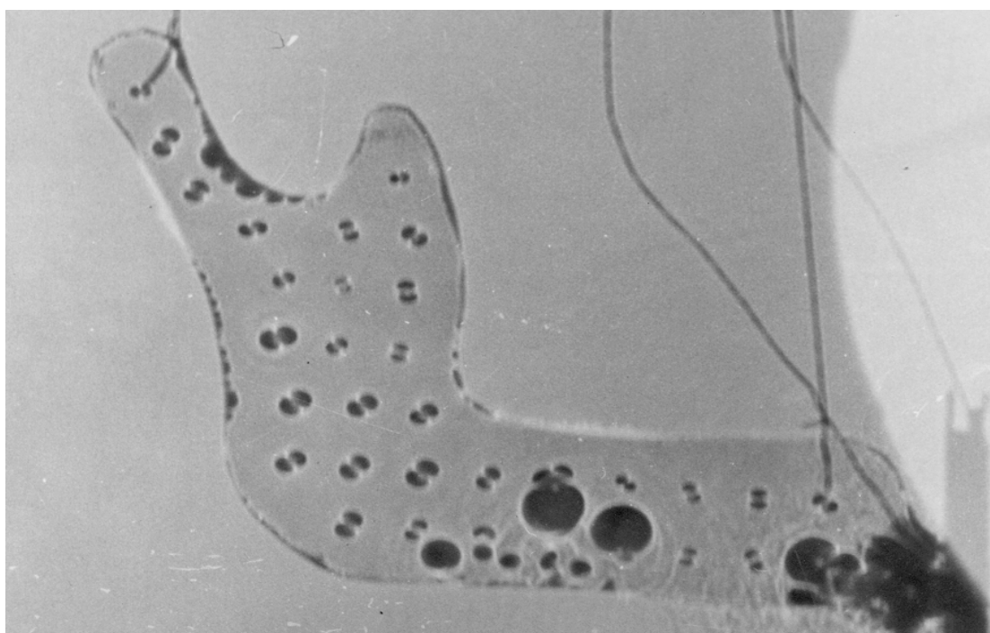
Σχήμα 4.17 Στιγμιότυπο διάδοσης του τασικού παλμού για το δοκίμιο στα 112 \mu\text{sec}
