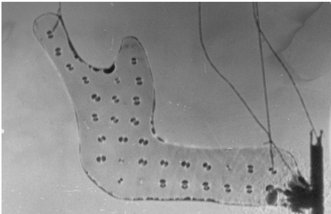
Σχήμα 4.13 Στιγμιότυπο διάδοσης του τασικού παλμού για το δοκίμιο στα 80 μsec
