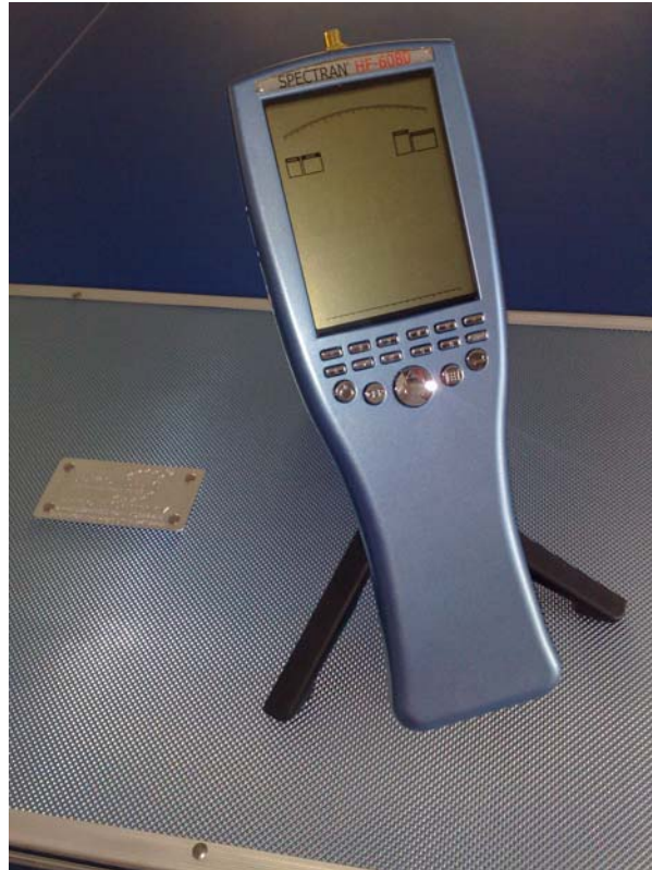
Εικόνα 5.1 –Αναλυτής φάσματος AARONIA Spectran HF-6080
