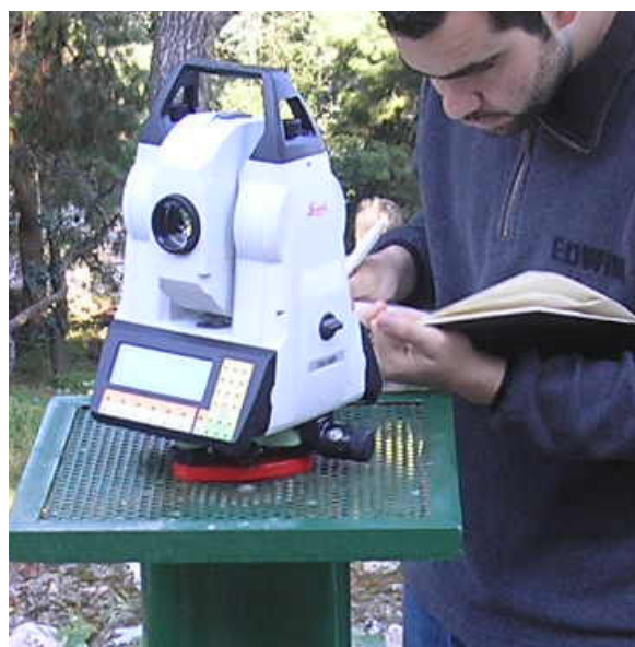
Εικόνες 11 και 12 – Απόψεις του οργάνου Leica TDA-5005
