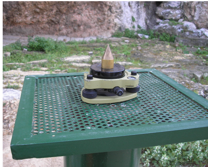
Εικόνες 9 και 10 – Απόψεις των βάσεων που υλοποίησαν τα σημεία αναφοράς
