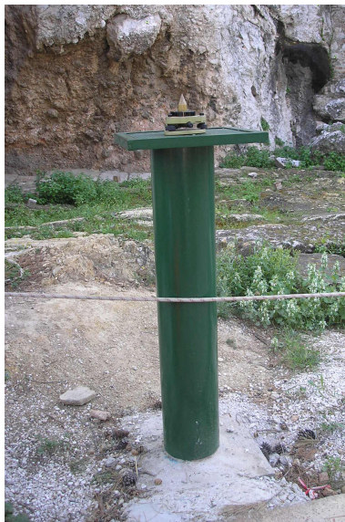
Εικόνες 9 και 10 – Απόψεις των βάσεων που υλοποίησαν τα σημεία αναφοράς
