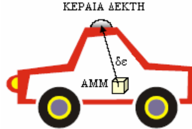
Εικόνα 4.10 : Εκκεντρότητα κεραίας δέκτη και ΑΜΜ
