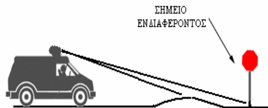
Εικόνα 4.4 : Αρχή λειτουργίας ΚΧΣ
