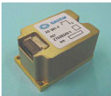
Εικόνα 2.17 : Επιταχυνσιόμετρο με ανίχνευση δονήσεων
