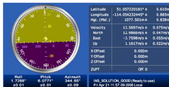
Εικόνα 5.11 : Το παράθυρο παρακολούθησης (INS window) του συστήματος SPAN
