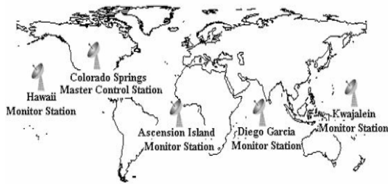
Εικόνα 3.3 : Τμήμα ελέγχου GPS (Πηγή :GPS review)
