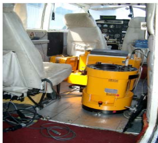
Εικόνα 4.2 : Κάμερα LMK με ενσωματωμένο ΟΑΔΣΠ (Πηγή : Novatel Inc.)
