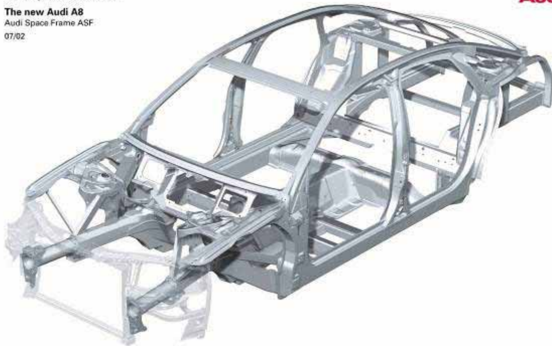
Σχήμα 3.54: Το αλουμινένιο πλαίσιο του Audi A8
