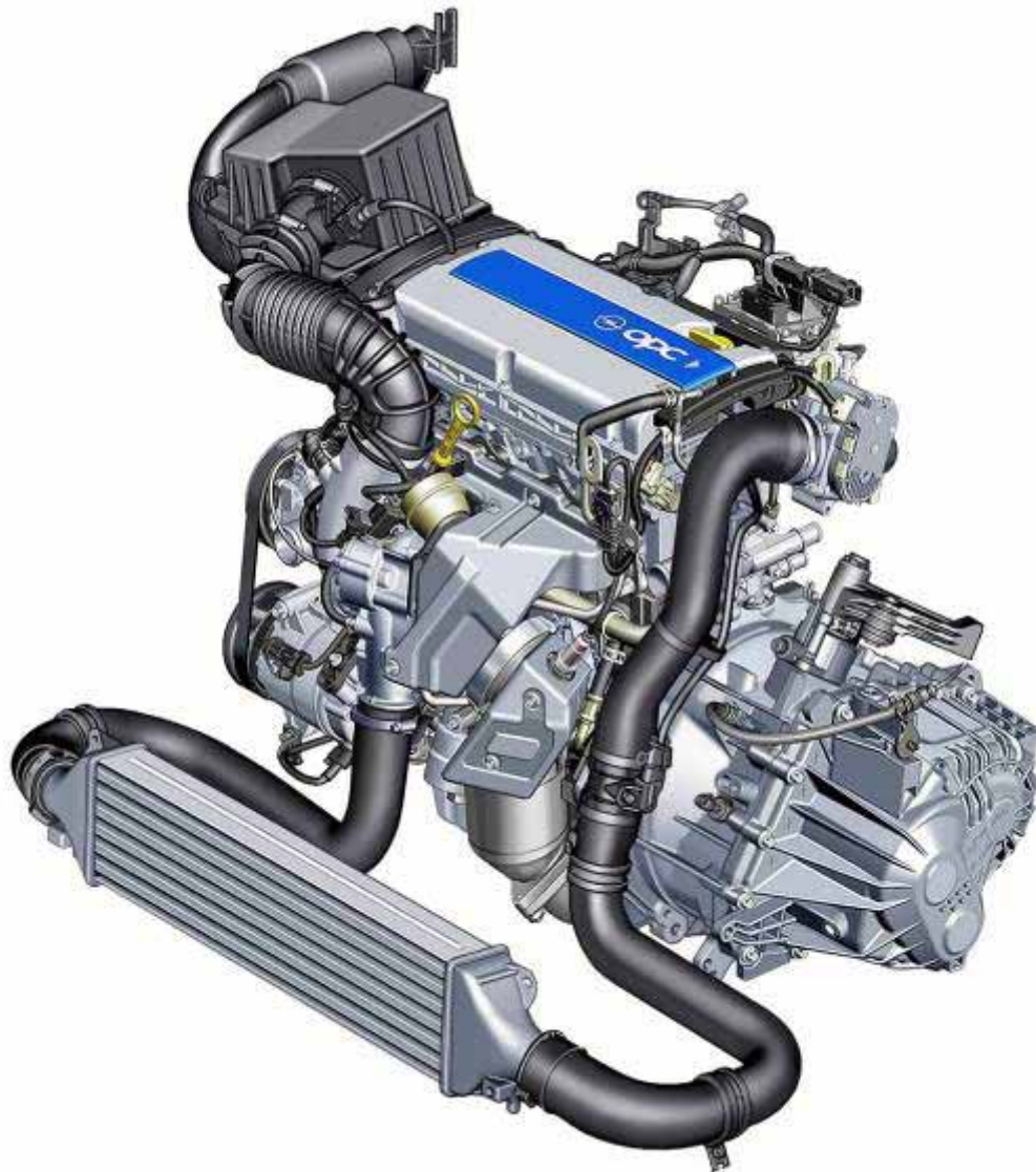
Σχήμα 3.33: Ο υπερτροφοδοτούμενος κινητήρας του Corsa OPC
