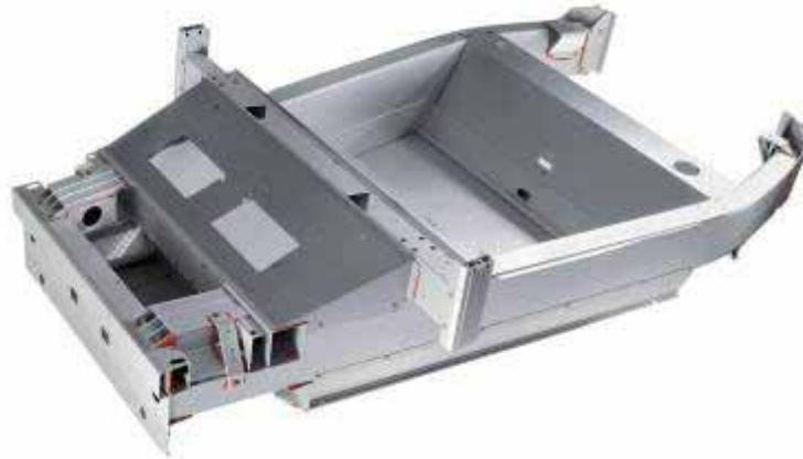
Σχήμα 3.21: Το αλουμινένιο πλαίσιο τύπου “μπαγιέρα” της Lotus Elise
