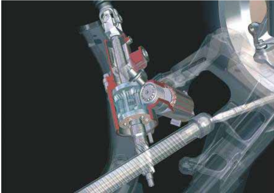
Σχήμα 3.5: Τομή του πλανητικού συστήματος του Active Steering
