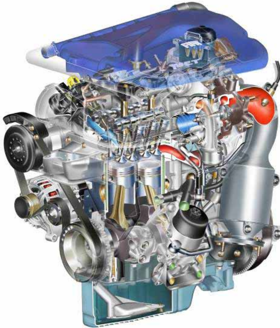
Σχήμα 3.12: Σχέδιο-φάντασμα του συστήματος κινητήρα T-JET
