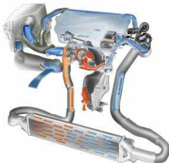
Σχήμα 3.13: Η ροή των αερίων στο κύκλωμα υπερτροφοδότησης του T-JET
