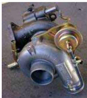
Σχήμα 3.45: Ο στροβιλοσυμπιεστής (turbo) του Impreza WRX STi
