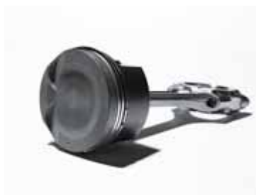
Σχήμα 3.46: Το σφυρήλατο έμβολο του κινητήρα M16A
