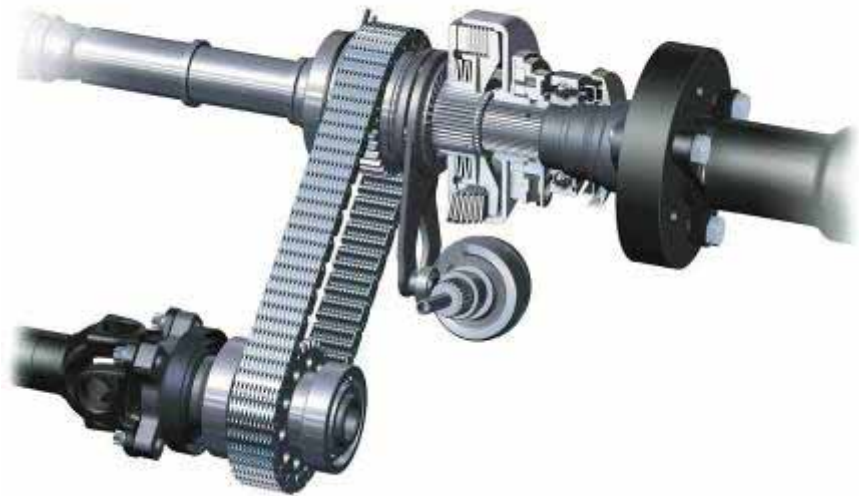
Σχήμα 3.10: Το συγκρότημα μεταφοράς ισχύος του συστήματος xDrive
