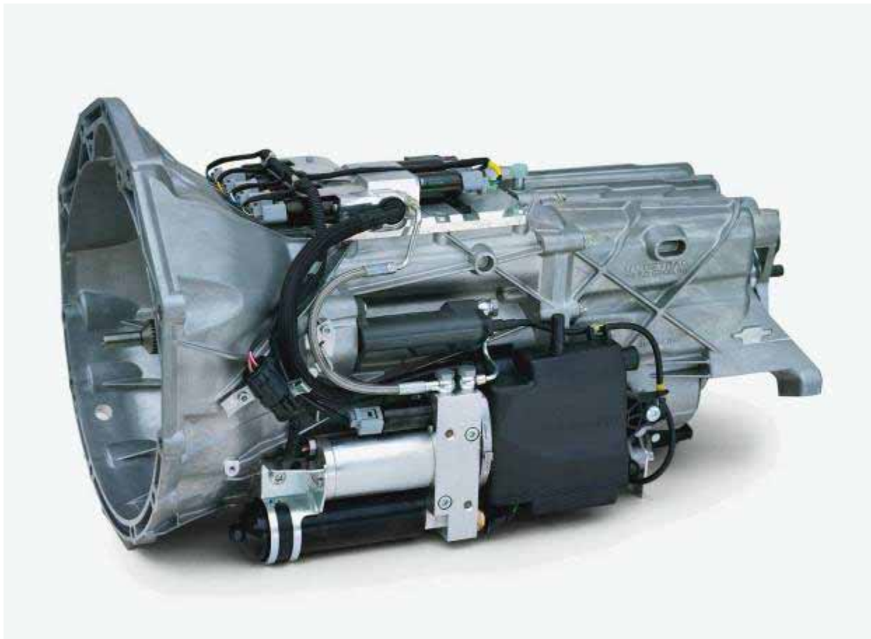
Σχήμα 3.7: Το κέλυφος του SMG μαζί με τα ηλεκτρομηχανικά υποσυστήματα του
