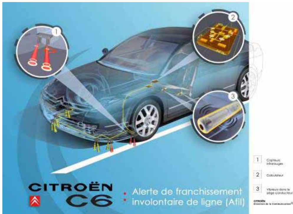
Σχήμα 3.41: Οι αισθητήρες και η μονάδα ελέγχου του συστήματος LDWS
