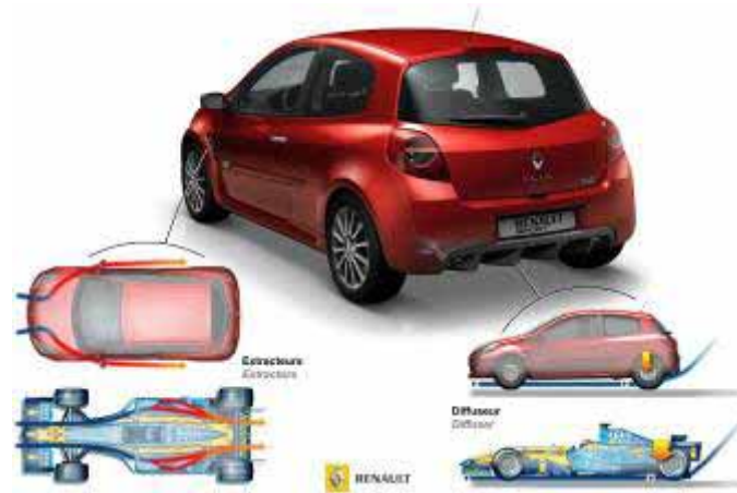
Σχήμα 3.42: Η ροή του αέρα γύρω από το Clio RS σε σχέση με το μονοθέσιο F1
