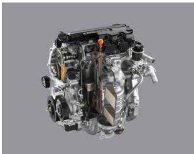
Σχήμα 3.16: Τομή κινητήρα τεχνολογίας i-VTEC
