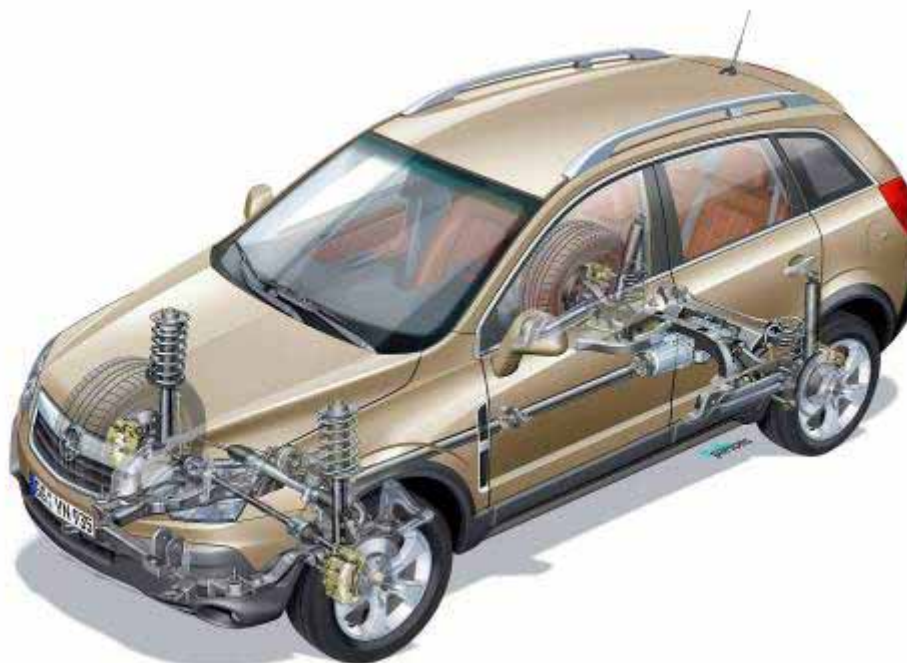
Σχήμα 3.34: Σχέδιο τύπου “φάντασμα” των μηχανικών μερών του Antara
