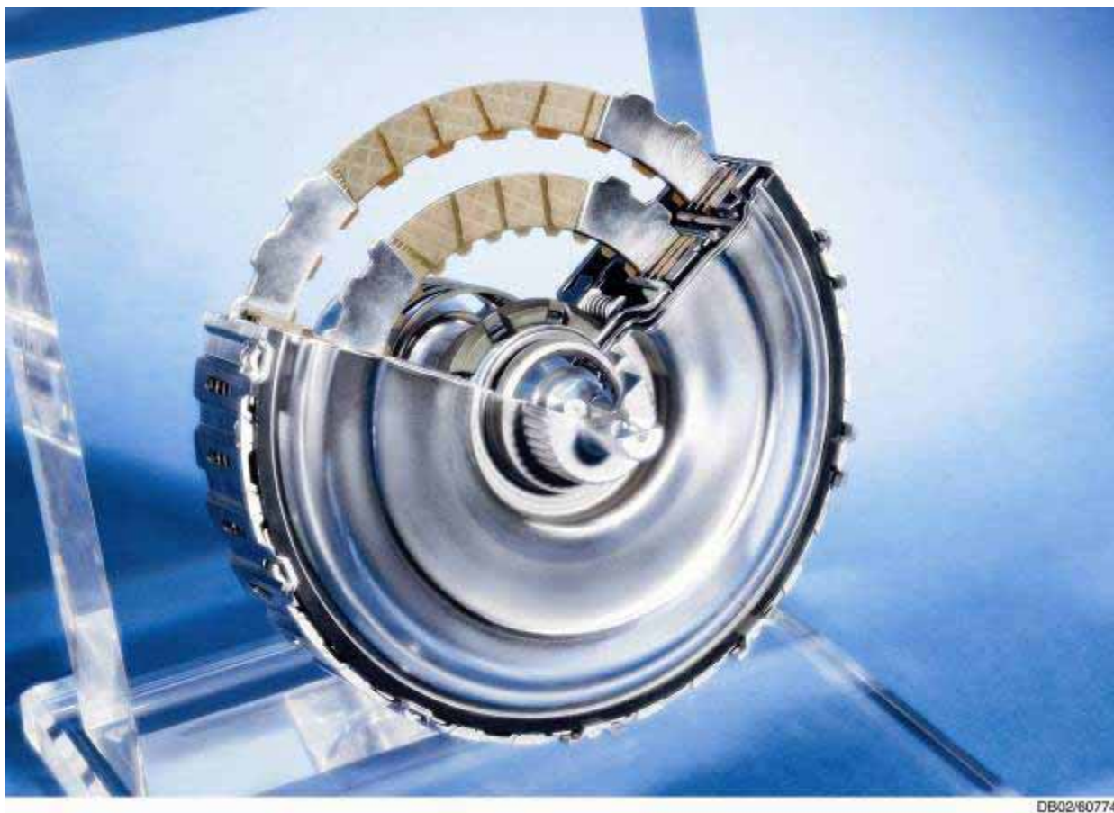
Σχήμα 3.51: Τομή του διπλού πολύδισκου συμπλέκτη του DSG
