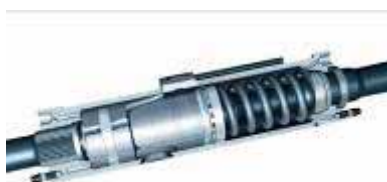
Σχήμα 3.39: Αμορτισέρ τεχνολογίας PASM σε τομή
