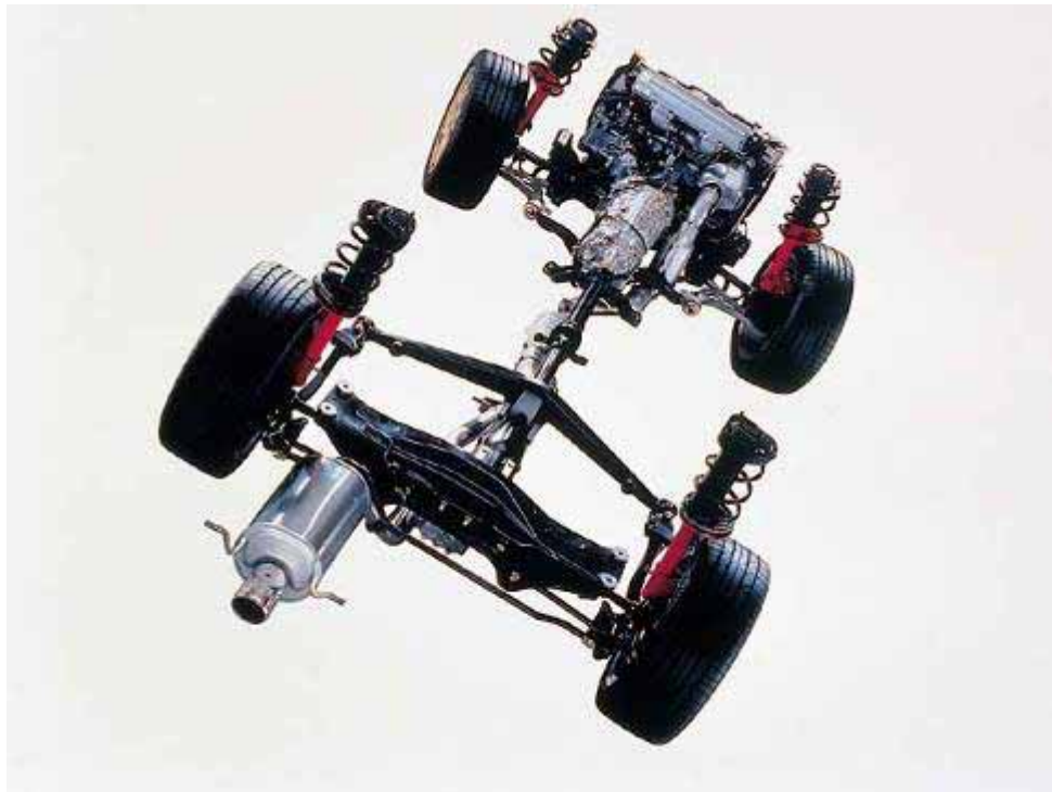
Σχήμα 3.44: Το συμμετρικό σύστημα τετρακίνησης της Subaru
