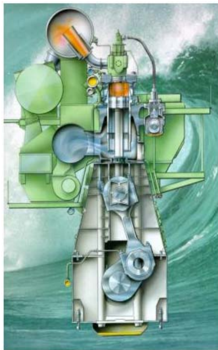
Σχήμα 1.4 Σειρά κινητήρων MAN B&W MC με διαμήκη απόπλυση
