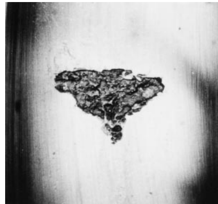
Σχήμα 1.5 : Pitting σε επιφάνεια κύλισης, πηγή: FAG - Waelzlagerschaden
