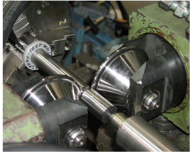
Σχήμα 2.9 : Παράδειγμα διάταξης κατεργασίας Deep Rolling. Στην εικόνα διακρίνονται δυο ραούλα και το κυλινδρικό κατεργαζόμενο τεμάχιο.
