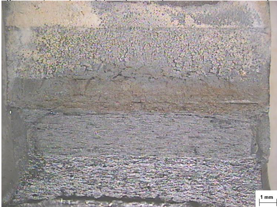
Σχ.4.2 Επιφάνεια μετά τη θραύση από δοκίμιο το οποίο έσπασε σε περιβάλλον υδρογόνου
