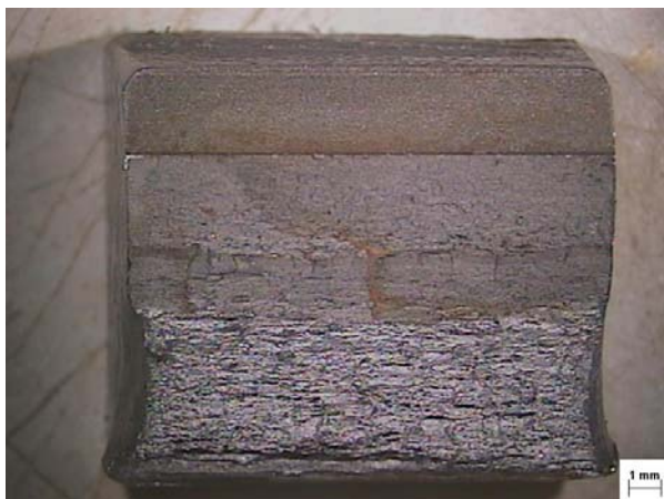
Σχ.3.7 Χαρακτηριστική επιφάνεια θραύσης δοκιμίου σε περιβάλλον υδρογόνου.
