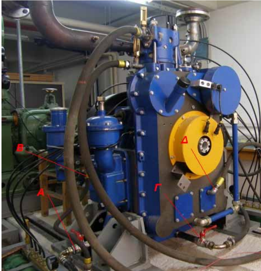
Εικόνα 8.9. Είσοδοι και οι έξοδοι από την ελαιολεκάνη του κινητήρα.
