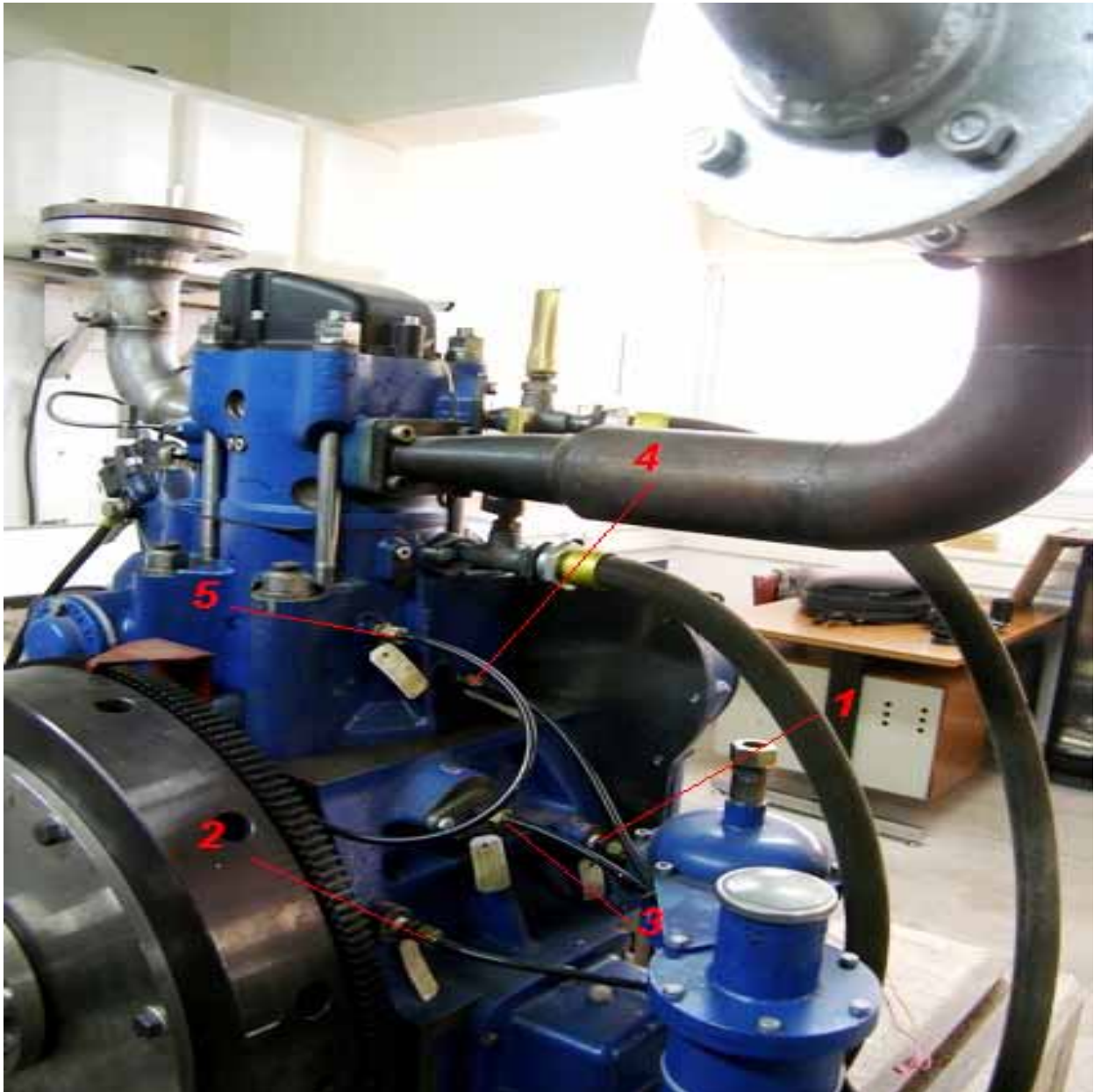
Εικόνα 8.3. Σημεία λίπανσης κινητήρα από το κύκλωμα Νο1.
