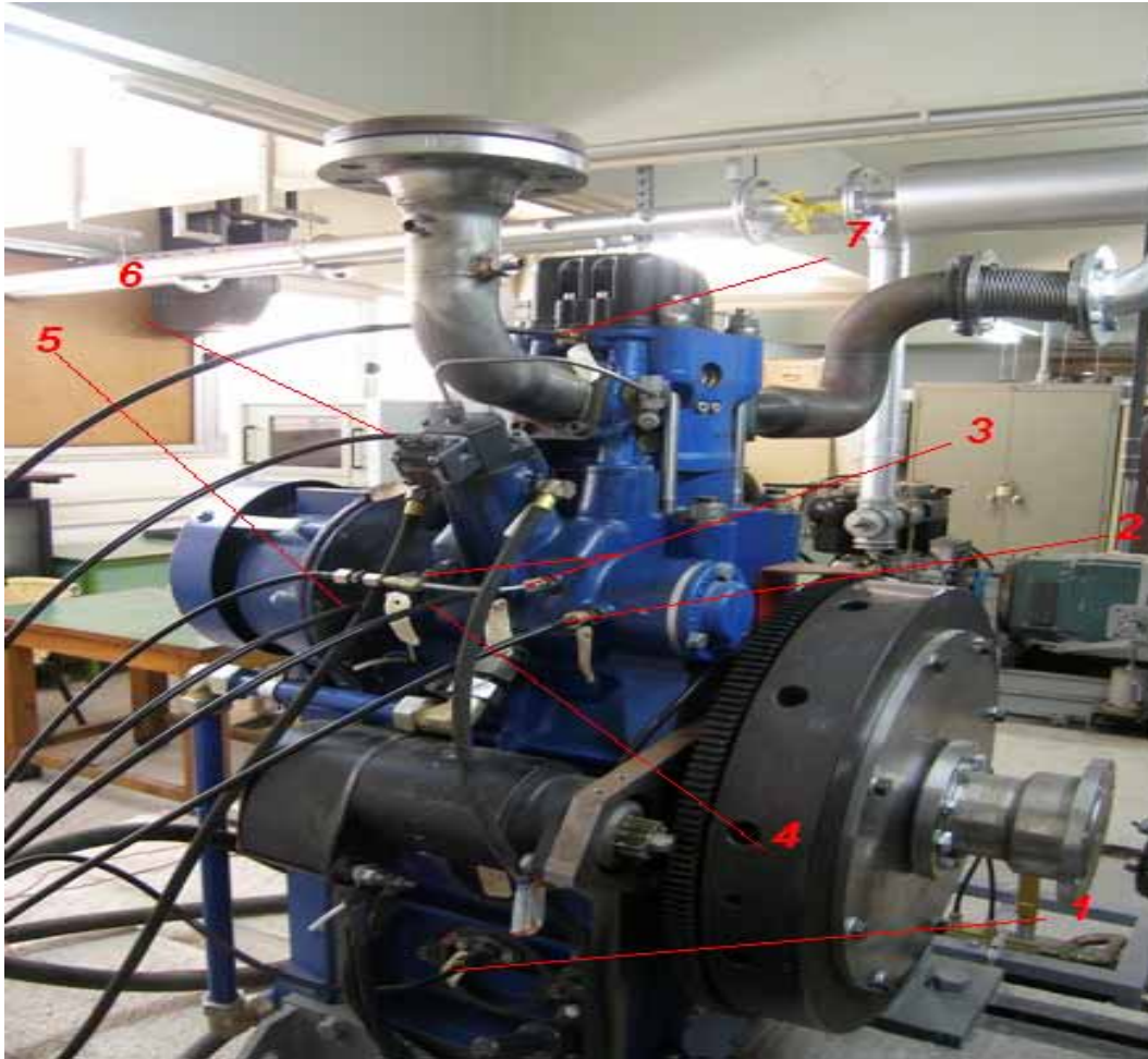
Εικόνα 8.8. Στην εικόνα φαίνονται τα σημεία λίπανσης του κυκλώματος No2.
