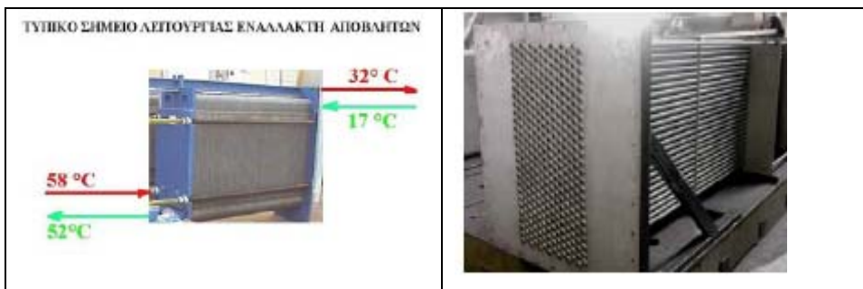
Εικόνα 108: Εναλλάκτες αποβλήτων. Αριστερά πλακοειδης και δεξιά σωληνωτός [10]
