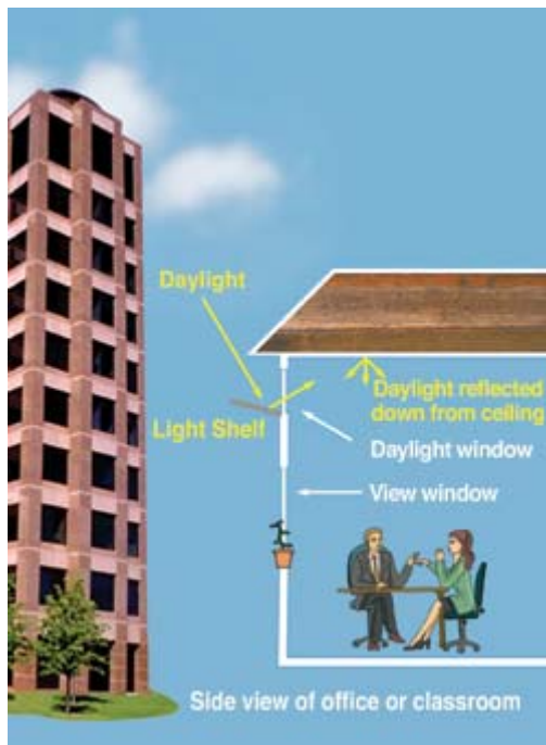
Εικόνα 89: Πόσο βαθιά σε ένα δωμάτιο μπορεί να φτάσει το φυσικό φως, ανάλογα με τις διαστάσεις του παραθύρου, συνδυασμένο με ράφι φωτισμού [58]
