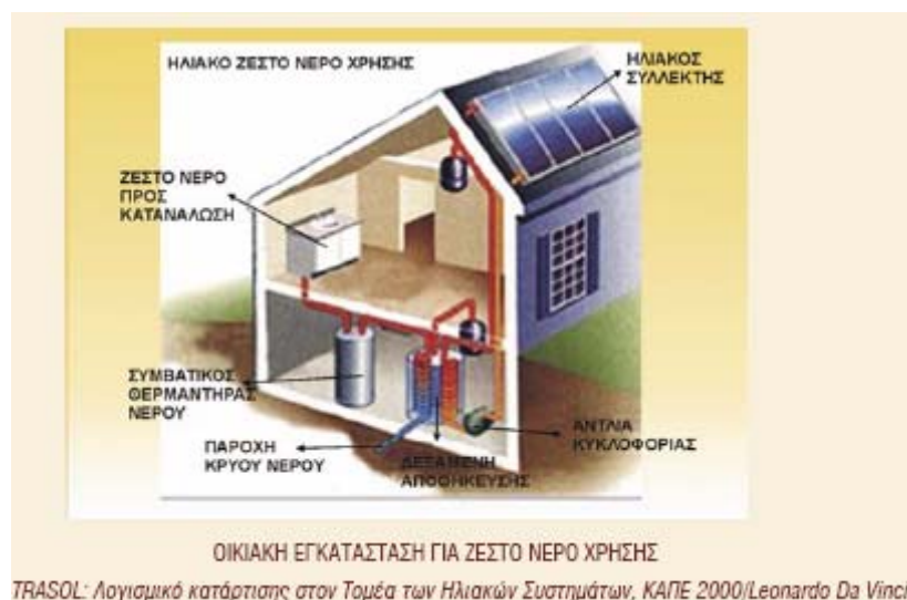
Εικόνα 98: Παραγωγή ζεστού νερού χρήσης με ηλιακά
