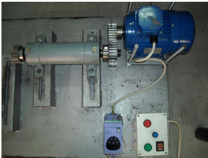
Εικόνα 7.5-1: Μετρητική διάταξη με βαθμίδα οδοντωτών τροχών
