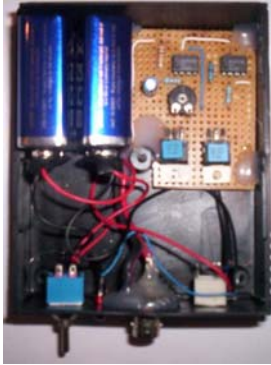
Εικόνα 5.2-1: Κύκλωμα Charge mode (PE)
