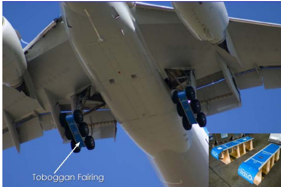
Σχήμα 1.7: Σύστημα προσγείωσης με χρήση αεροδυναμικού καλύμματος [16]
