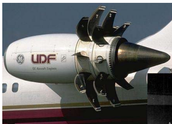
Σχήμα 2.3: Ο κινητήρας GE-36 unducted Fan
