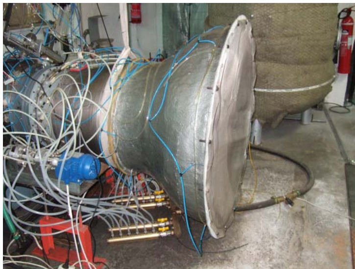
Σχήμα 5.9 (δεξιά): Κώνος που μπορεί να χρησιμοποιηθεί ως διαχύτης. Η κλίση του μετρήθηκε στις 5^\circ , η οποία είναι κατάλληλη τιμή για το σκοπό που θέλουμε να τον χρησιμοποιήσουμε. Ένα μέρος του μπορεί να κοπεί προκειμένου να μας εφαρμόζει στη φλάντζα του κυλινδρικού αγωγού εξόδου.
