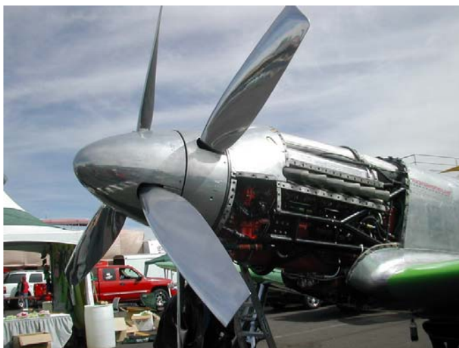
Σχήμα 2.1: Εμβολοφόρος κινητήρας Rolls-Royce Griffon με σύζευξη αντίθετα στρεφόμενων ελίκων για πρόωση τροποποιημένης έκδοσης αεροσκάφους P-51 Mustang
