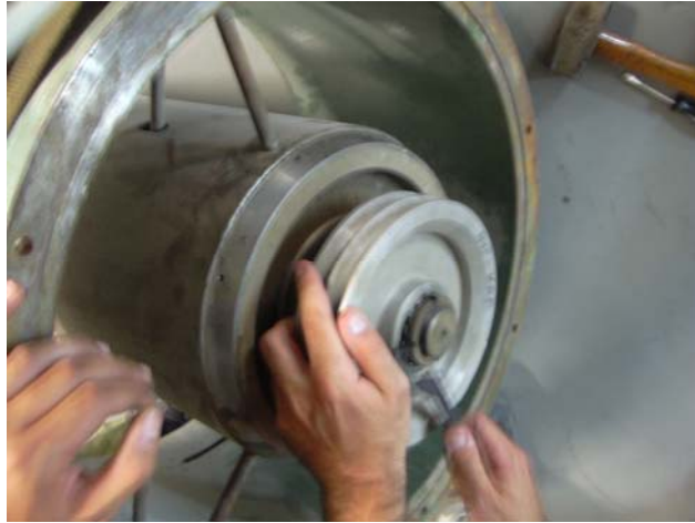
Σχήμα 8.57: Λύσιμο του σφιχτήρα (περικόχλιο ατράκτου) στερέωσης της τροχαλίας μέσω γαντζόκλειδου.
