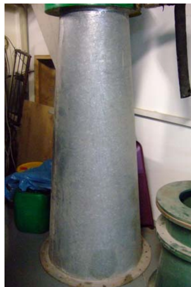
Σχήμα 5.9 (δεξιά): Κώνος που μπορεί να χρησιμοποιηθεί ως διαχύτης. Η κλίση του μετρήθηκε στις 5^\circ , η οποία είναι κατάλληλη τιμή για το σκοπό που θέλουμε να τον χρησιμοποιήσουμε. Ένα μέρος του μπορεί να κοπεί προκειμένου να μας εφαρμόζει στη φλάντζα του κυλινδρικού αγωγού εξόδου.
