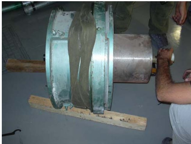
Σχήμα 8.58: Προετοιμασία για εξαγωγή της ατράκτου μέσω χτυπήματος με σφυρί. Διακρίνονται οι ξύλινοι πάσσαλοι για συγκράτηση της κατασκευής (μη περιστροφή) και το ελαστικό εξάρτημα παρεμβαλλόμενο ανάμεσα στην άτρακτο και το σφυρί κατά το χτύπημα.
