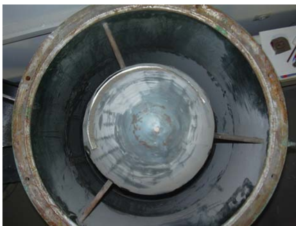
Σχήμα 5.7 (δεξιά): Όψη του δοκιμαστήριου υπό γωνία όπου και διακρίνονται μία τριάδα κοχλιών για τη στερέωση του εσωτερικού κελύφους στο εξωτερικό.
