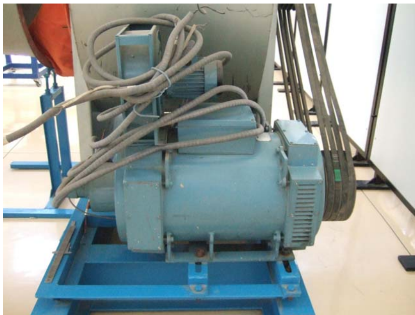
Σχήμα 7.52: Ηλεκτροκινητήρας συνεχούς ρεύματος D.C. που θα χρησιμοποιηθεί για την κίνηση του πρώτου ρότορα.
