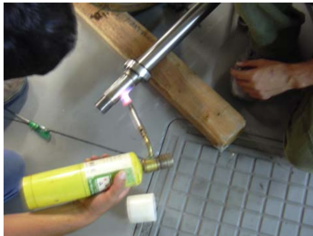
Σχήμα 8.59: Θέρμανση της ατράκτου με φλόγα για διαστολή της και εξαγωγή της σφήνας
