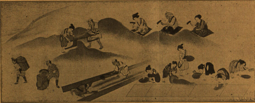
(Σχ. 2). Διαλογή, πλύσις και εμπλουτισμός μεταλλευμάτων.
