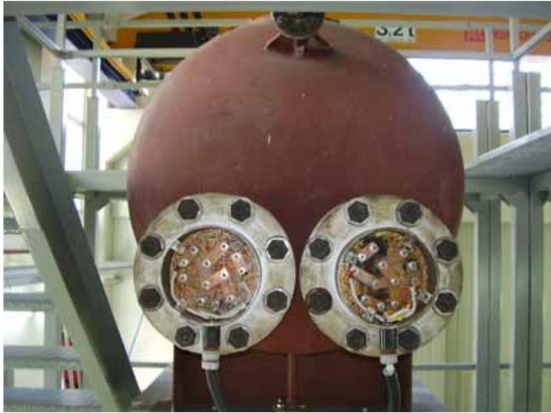
Σχήμα 3.5 ( Σύνδεση αντιστάσεων Α και Β στο δοχείο βρασμού)
