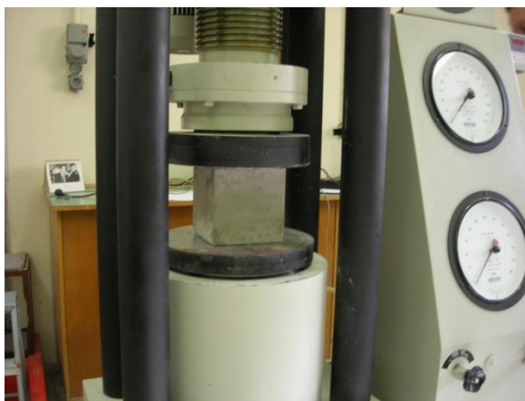
Σχήμα 2.6 - Η δοκιμή θλίψης των κυβικών δοκιμίων.
