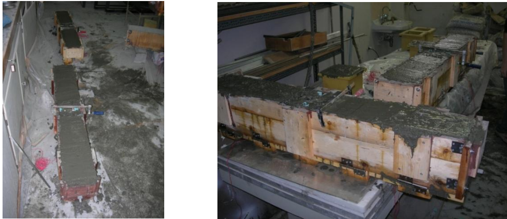
Σχήμα 2.7 - Οι πειραματικές δοκοί σε ξύλινα καλούπια.
