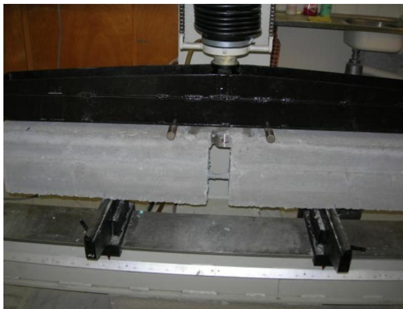
Σχήμα 2.8 - Πειραματική δοκός στην μηχανή κάμψης.
