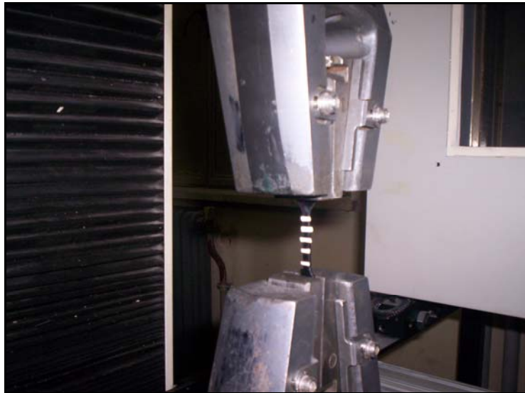
Εικόνα 6.6: Δοκίμιο κατά την διάρκεια του πειράματος εφελκυσμού
