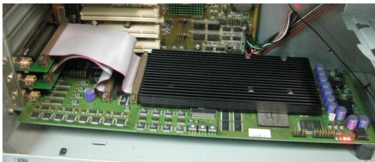
Εικόνα 3-1 dSpace DS1103 PPC Controller Board
