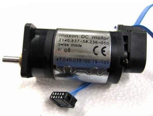
Εικόνα 2-9 incremental encoder σε κινητήρα DC με μειωτήρα βαθμίδας
