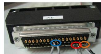
εδώ στέλνεται το σήμα – εντολή που παράγεται στο Simulink, ως τάση  $V(t)$ , προς τον Servoamplifier. Στα pin 36 και 37 είναι συνδεδεμένη η είσοδος του ADC7 (channel 7) και η γείωση αντίστοιχα. Το σήμα  $i(t)$  που παράγεται στον Servoamplifier εισέρχεται από εδώ και καταγράφεται στην
