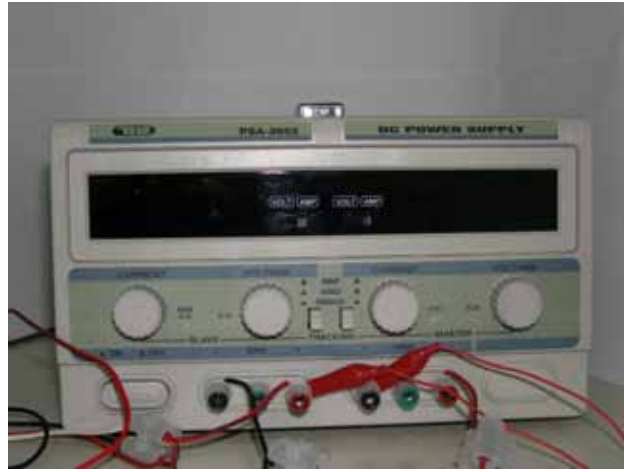
εικόνα 8: το τροφοδοτικό των δύο αισθητήρων πίεσης
