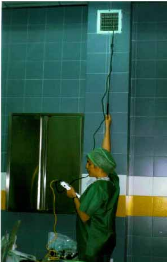
Εικόνα Β.1-3: μετρήσεις για την ταχύτητα του αέρα στην επιφάνεια μιας παροχής εισόδου του αέρα μέσα σε ένα χειρουργείο
