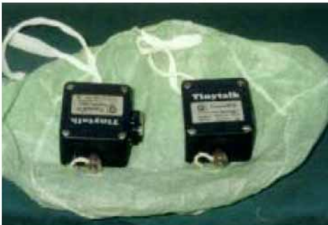
όργανο συλλογής μετρήσεων για τη θερμοκρασία και τη σχετική υγρασία
