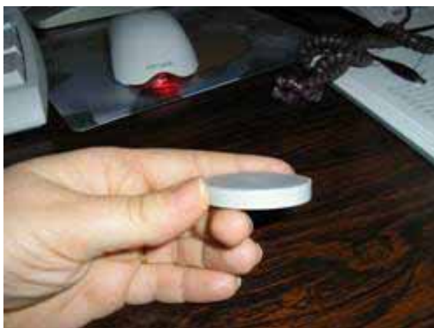
ΣΧΗΜΑ 2.26: Μορφοποιημένο δείγμα όπως βγαίνει από τη πρέσα.
