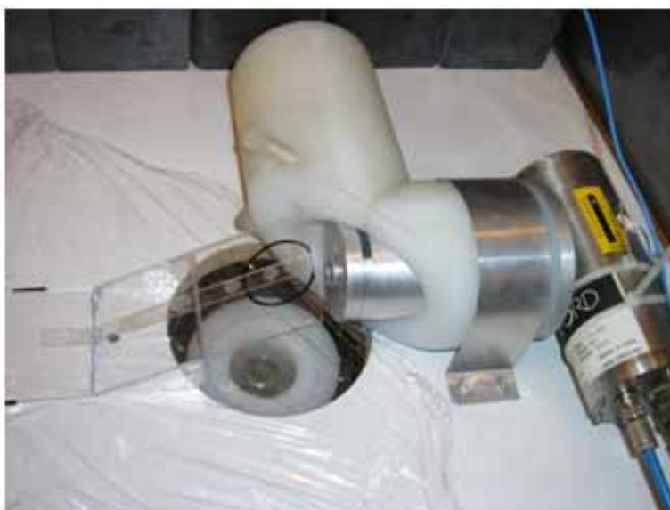
ΣΧΗΜΑ 2.24: Γεωμετρία θαλάμου ακτίνων Χ, ανιχνευτή και δείγματος(σε πλάγια όψη) καθώς και φωτογραφία του ανιχνευτή SiLi και του θαλάμου ακτίνων Χ.
