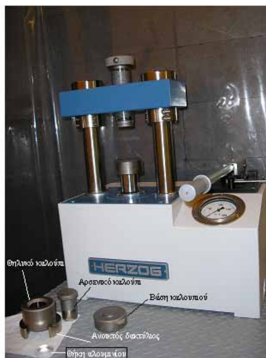
ΣΧΗΜΑ 2.25: Η υδραυλική πρέσα TP20 της Herzog του ΕΠΤ-ΕΜΠ για την προετοιμασία δειγμάτων XRF.
