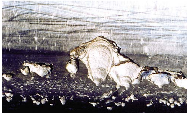
Σχήμα 3.3.1Σ4: Εκτεταμένη βλάβη γήρανσης στην επιφάνεια επαφής του δοντιού.
