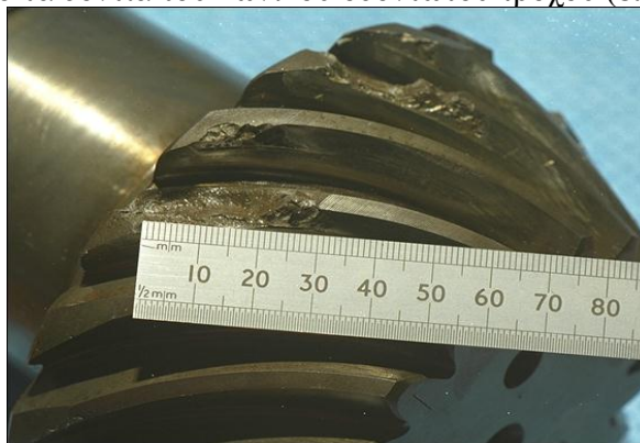
Εικόνα 4.4Σ4: Εκτεταμένες φθορές του κωνικού πινιόν.
