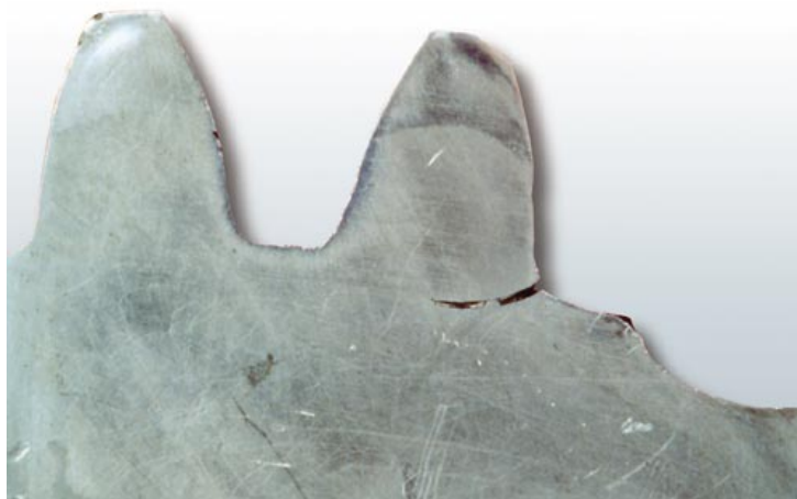
Σχήμα 3.3.3Σ2: Έναρξη ρωγμής στην βάση του οδόντα
