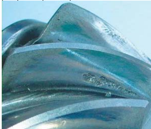
Σχήμα 3.3.1Σ2: Τυπική βλάβη μηχανικής κόπωσης με την εμφάνιση μιας θρυμματισμένης περιοχής, πιθανότατα λόγω κακής ευθυγράμμισης—Labs, Dept. Mech. Engr., PoliMI
