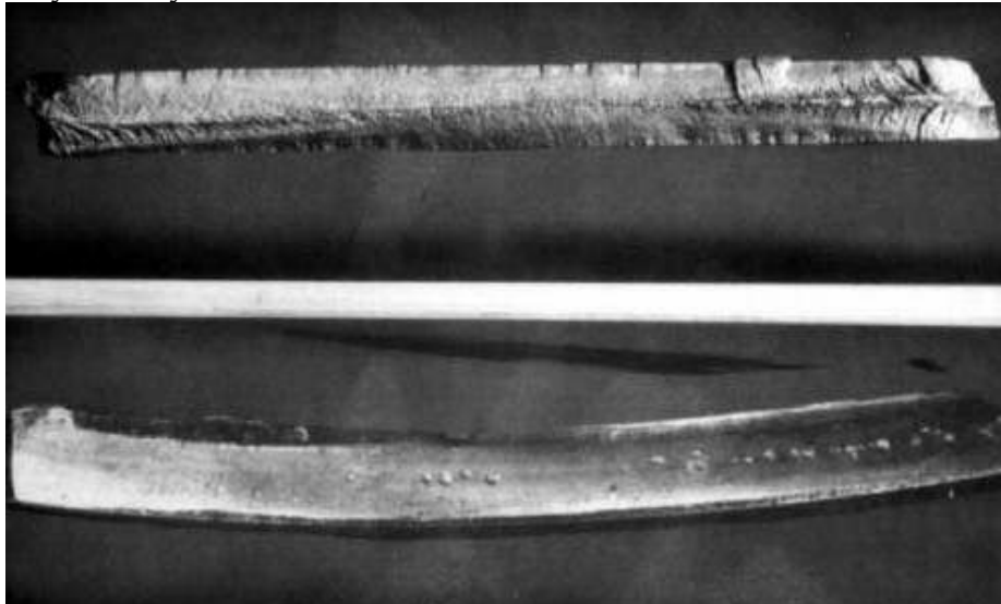
Σχήμα 3.3.6Σ4: Δόντι που έσπασε λόγω επίδρασης στρεπτικής πίεσης αναστροφής. Οι ρωγμές καταπόνησης έχουν διαδοθεί προς το εσωτερικό εξίσου και προς τις δύο πλευρές.
