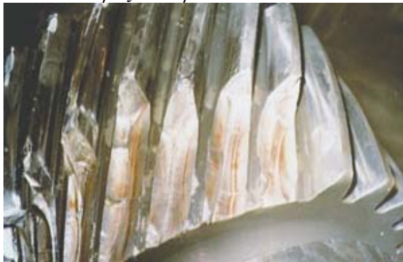
Σχήμα 3.3.6Σ3: Καταστροφή καμπτικής καταπόνησης ενός βιομηχανικού οδοντωτού τροχού λόγω μεγάλης διακύμανσης τάσης—FZG, TU Munchen, Germany
