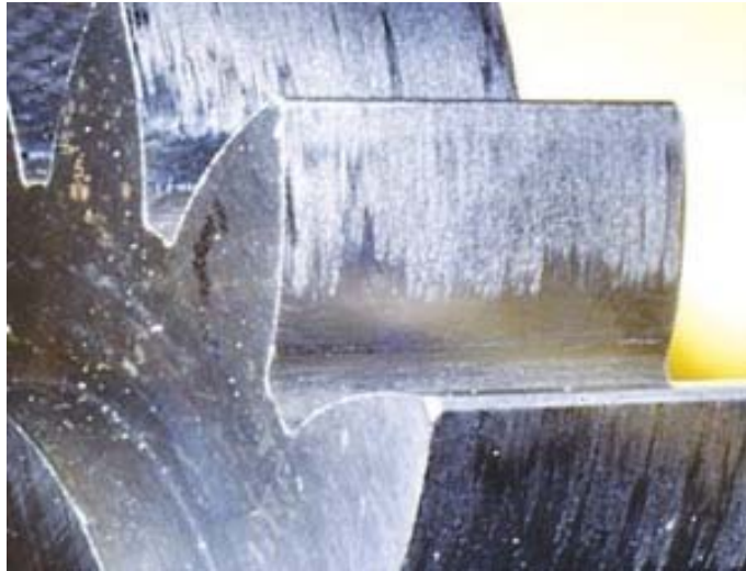
Σχήμα 3.3.4Σ1,2: Σοβαρή χάραξη της επιφάνειας σε γρανάζια δοκιμών-FZG, TU Munchen, Germany
