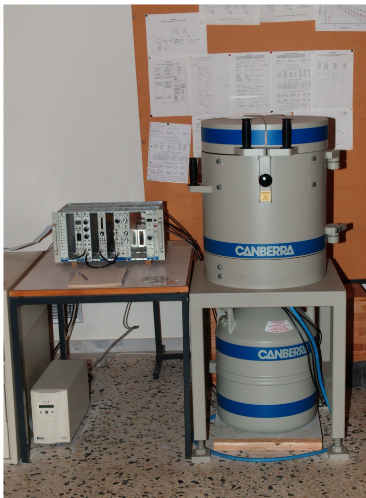
Σχήμα 5-2: Ανιχνευτής XtRA και διάταξη επεξεργασίας σήματος
