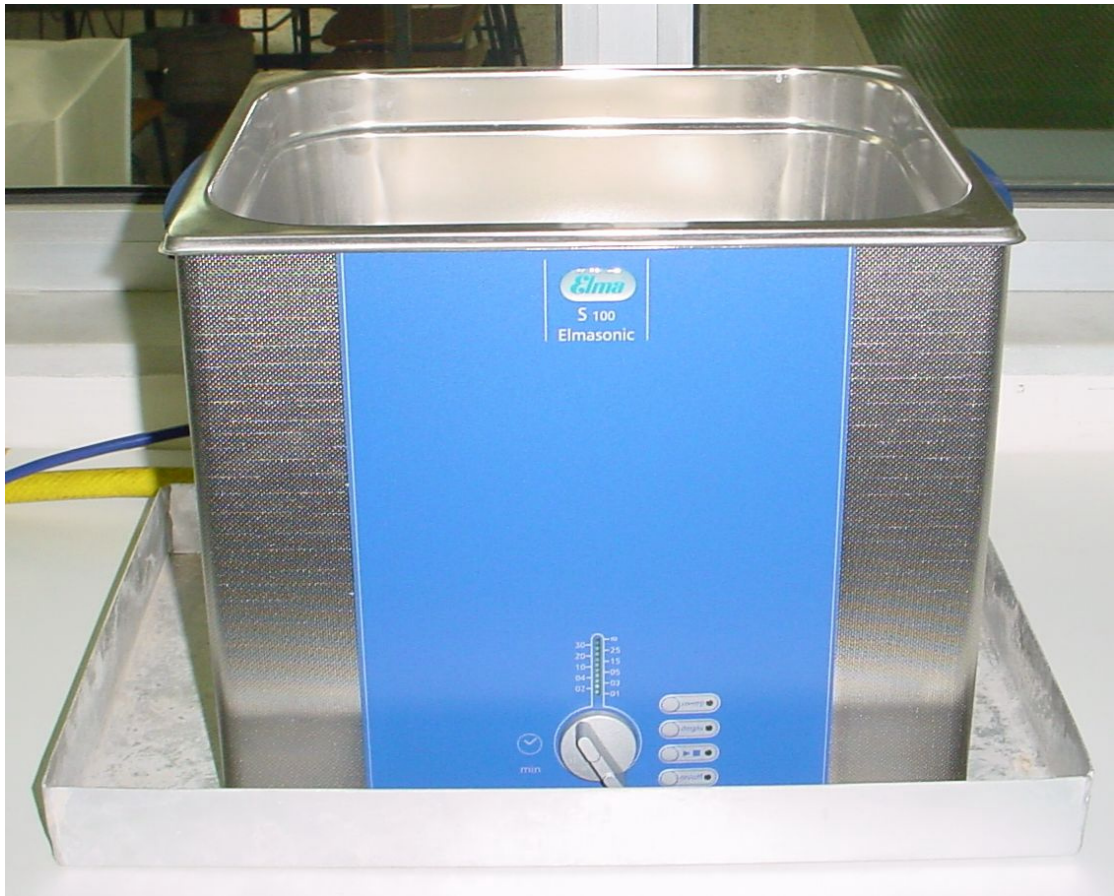
Σχήμα 4-4: Συσκευή καθαρισμού Elmasonic S100
