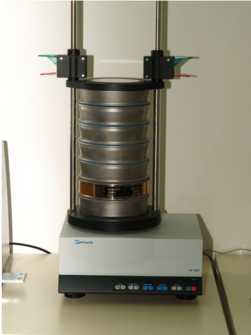
Σχήμα 4-1: Μηχανή κοσκινίσματος AS 200 control
