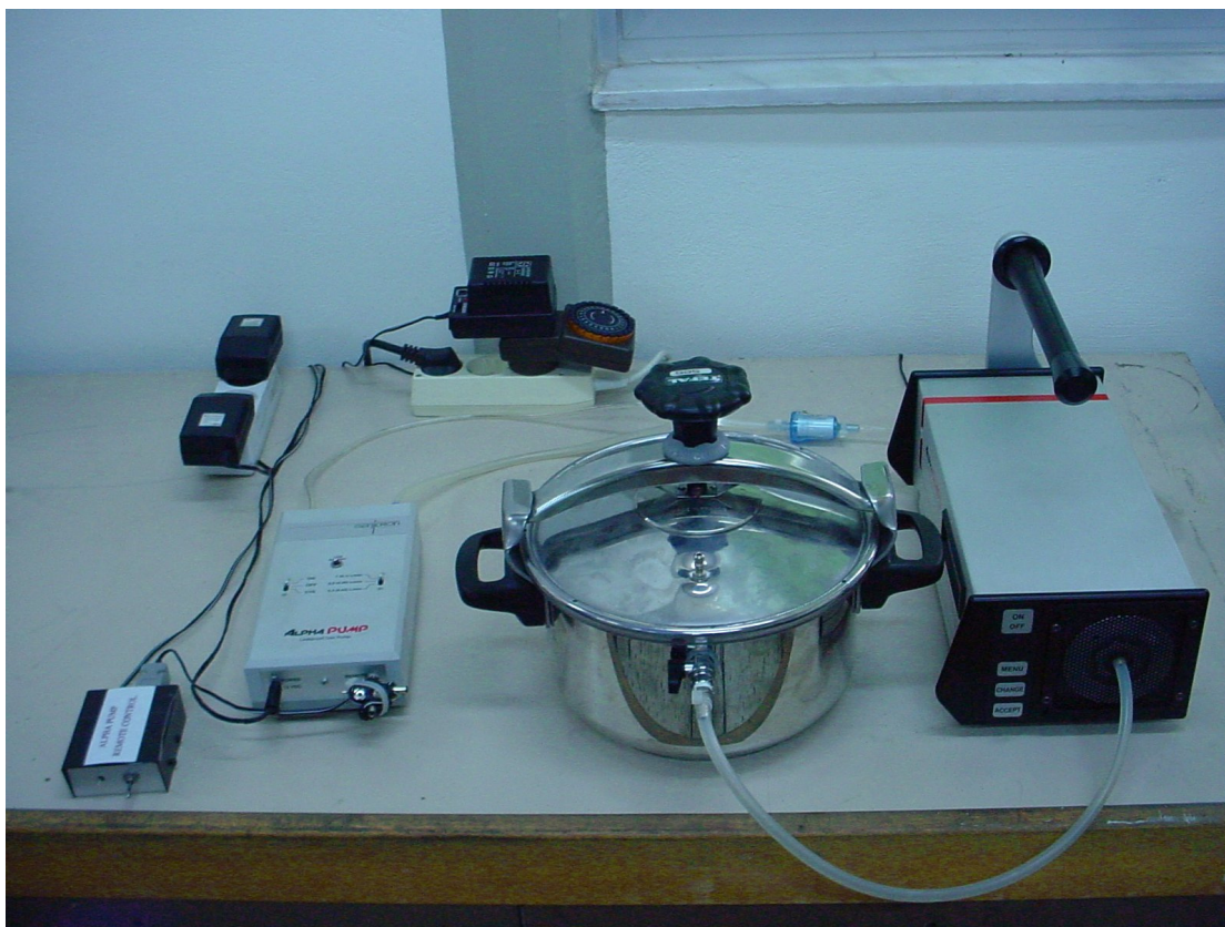
Σχήμα 5-19: Διάταξη μέτρησης εκροής Ραδονίου
