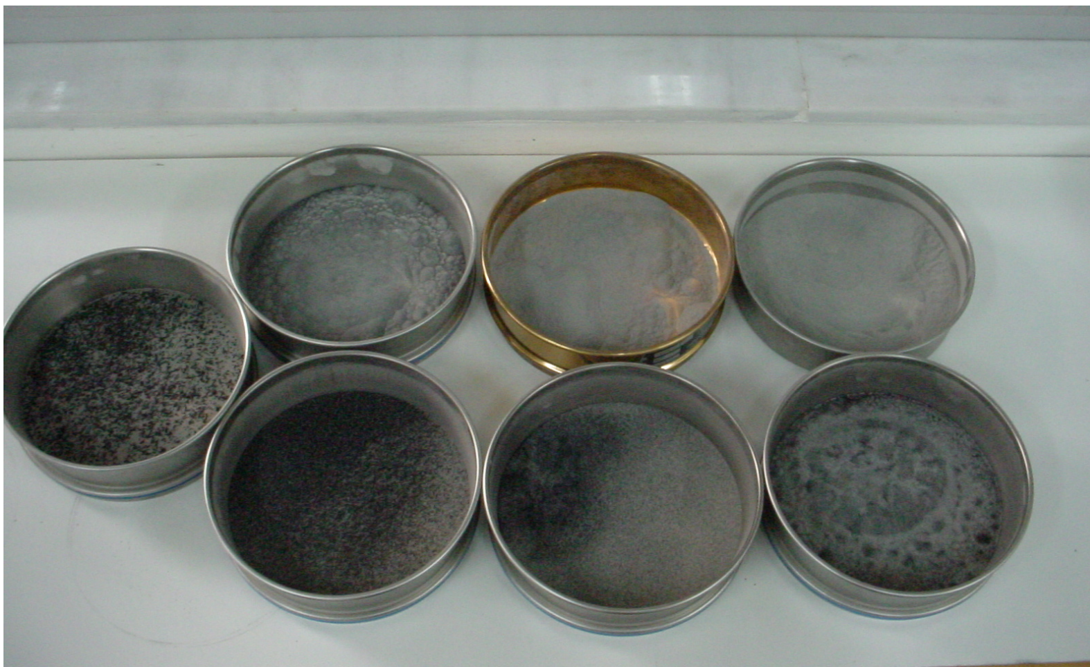
Σχήμα 4-19: Κόσκινα διάφορων κλασμάτων με Ιπτάμενη Τέφρα Studstrup μετά την ολοκλήρωση της διαδικασίας κοσκινίσματος
