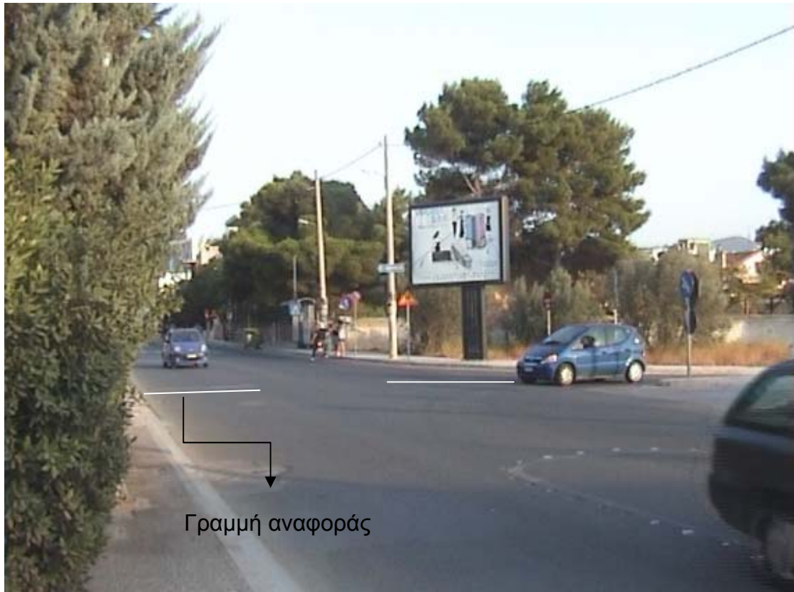
Εικόνα 3.5: Παρουσίαση Οπτικού Πεδίου Καταγραφής από την Βιντεοκάμερα για την Μέτρηση του Κρίσιμου Διακένου
