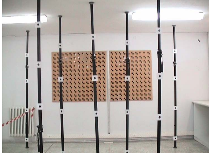
Εικόνα 3.10: Παράδειγμα Καταγραφής Αντικειμένου σε Μικρή Κλίμακα για τον Προσδιορισμό του Μεγέθους του Εικονοστοιχείου.
