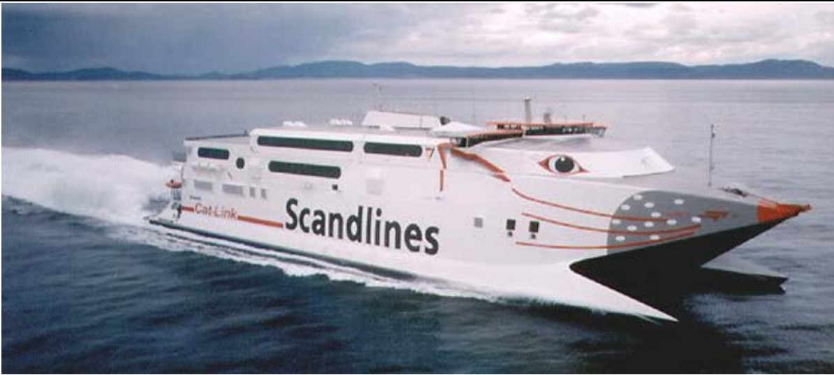
Εικόνα 11.6 : Καταμαράν κατασκευασμένο από κράμα Αλουμινίου
