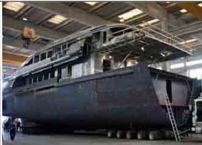
Εικόνα 11.7 :Ιστιοφόρο κατασκευασμένο από κράμα Αλουμινίου , γιουτ υπό κατασκευή
