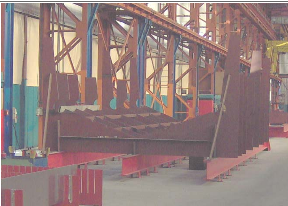
Εικόνα 7.1- Η χαλύβδινη ιδιοσυσκευή πακτωμένη ευθυγραμμισμένη με τις γραμμές του πρυμναίου τομέα S01
