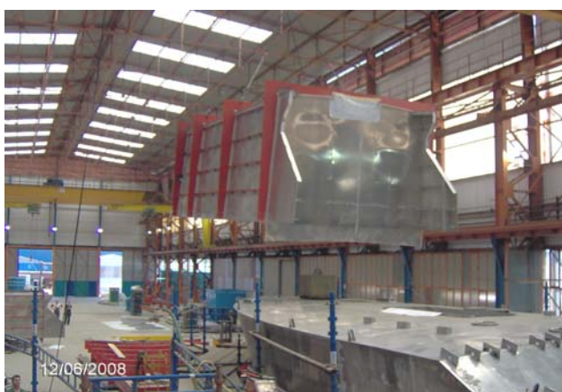
Εικόνα 7.9: Η ανέγερση του S03 επί του S01 και S02 η ιδιοσυσκευή της Υπερκατασκευής χρησιμοποιήθηκε και ως ζυγός ανέγερσης της.
