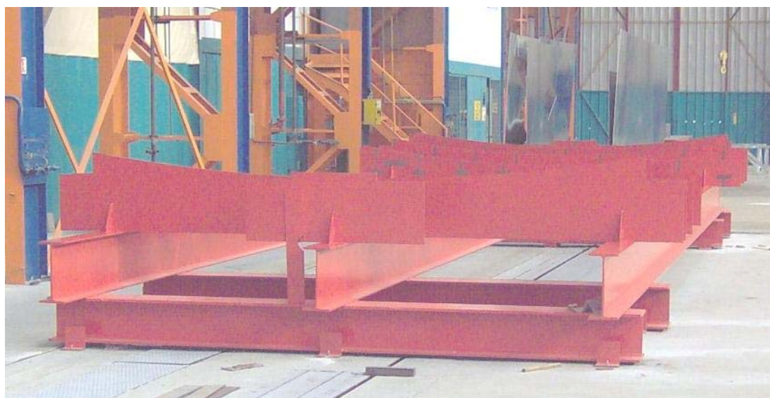
Σχήμα 5.11: Ιδιοσυσκευή Προκατασκευής ΥποΤομέα B07 Transom
