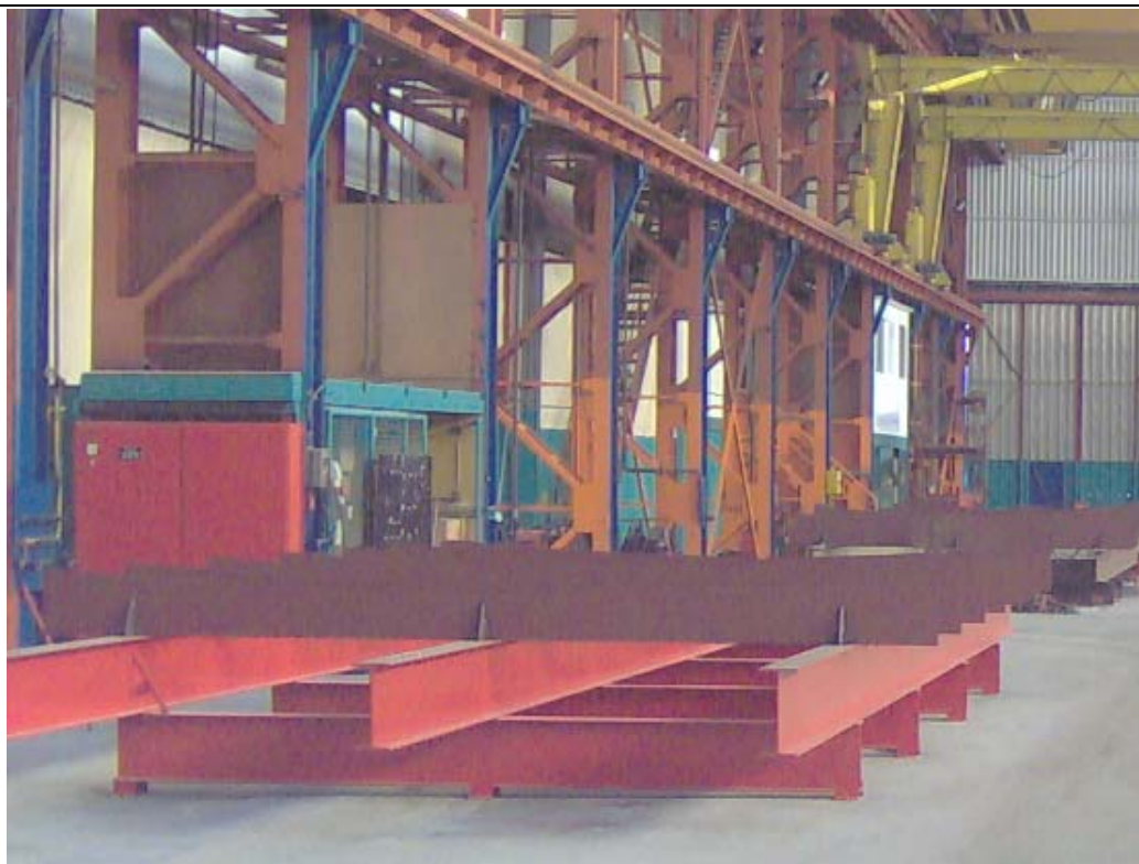
Εικόνα 7.2- Η χαλύβδινη ιδιοσυσκευή πακτωμένη ευθυγραμμισμένη με τις γραμμές του Πρωραίου τομέα S02
