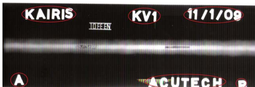
6.11. Μολυβδογράμματα και τρόπος τοποθέτησης και απεικόνισης πάνω στο φίλμ
