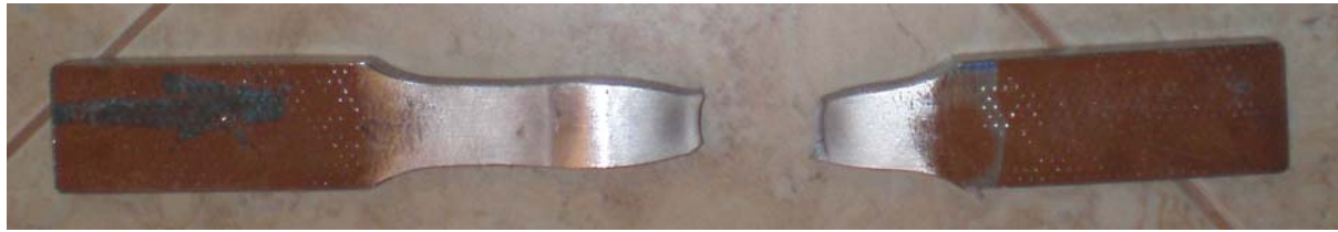
Το δοκίμιο 4 μετά τον εφελκυσμό έσπασε δεξιά και εκτός της συγκόλλησης
