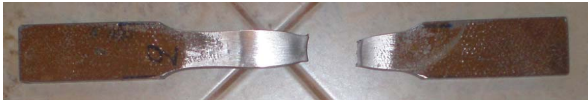
Το δοκίμιο 2 μετά τον εφελκυσμό έσπασε δεξιά και εκτός της συγκόλλησης
