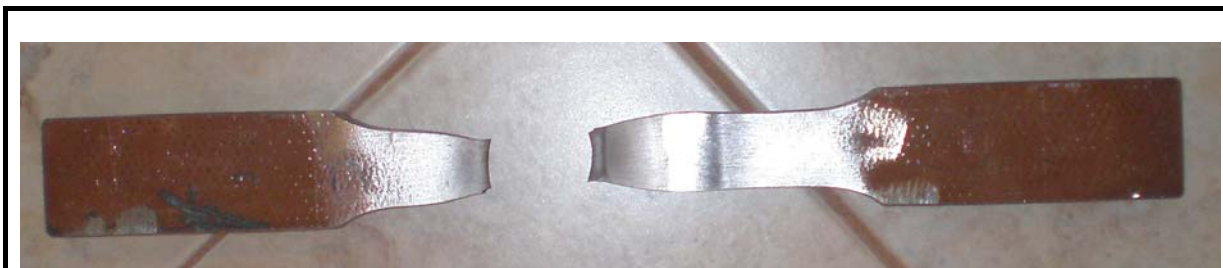
Το δοκίμιο 3 μετά τον εφελκυσμό έσπασε αριστερά και εκτός της συγκόλλησης
