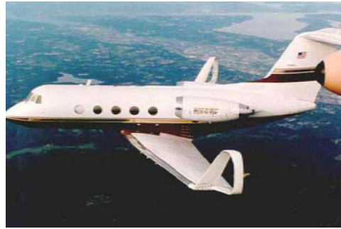
Σχήμα 34. Αεροσκάφος με σπειροειδή διαμόρφωση στα ακροπτερυγία.
