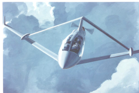
Σχήμα 37. Ο σχεδιασμός ενωμένων πτερύγων μειώνει σχετικά λίγο την επαγόμενη αντίσταση, αλλά μειώνει αποτελεσματικά την αντίσταση trim.
