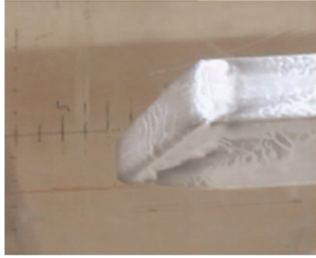
Σχήμα 45. Φυσαλίδα αποκόλλησης στην περιοχή σύνδεσης του ρύγχους με το σώμα στην κατακόρυφη πλευρά (γωνία πρόσπτωσης = 30^\circ , γωνία διατοιχισμού = 0^\circ ), ροή από τα αριστερά στα δεξιά.
