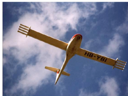
Σχήμα 33. Αεροσκάφος με winggrid διαμόρφωση στα ακροπερυγία.
