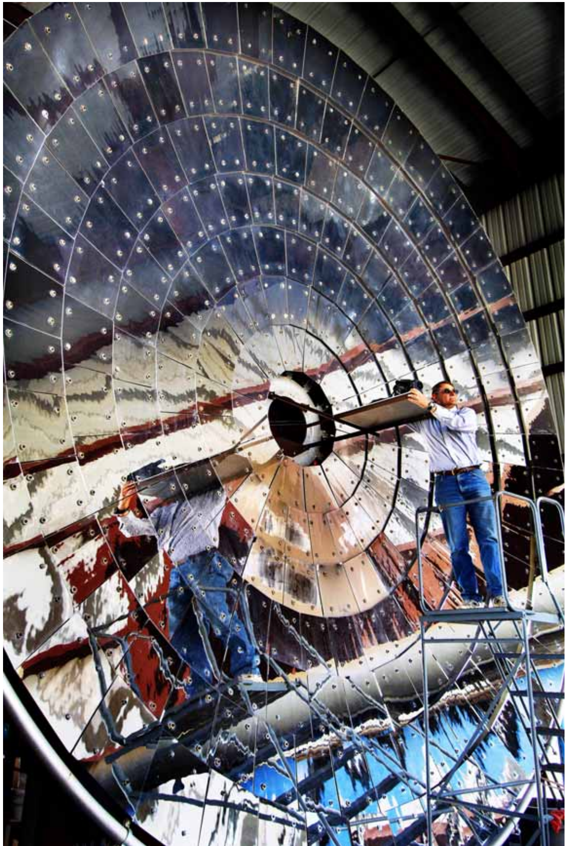
Σχήμα 4.11 Ο ηλιακός κλίβανος της τεχνολογίας S2P
