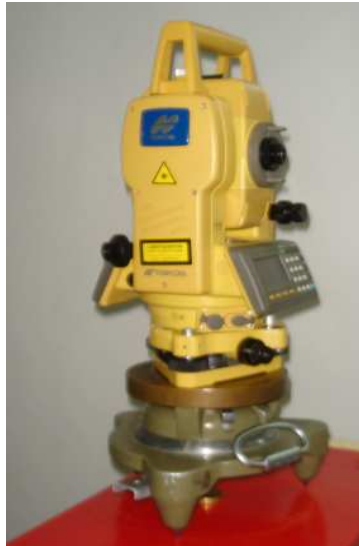
Φωτ. 2.8: Ο ολοκληρωμένος γεωδαιτικός σταθμός Topcon GPT3003LN
