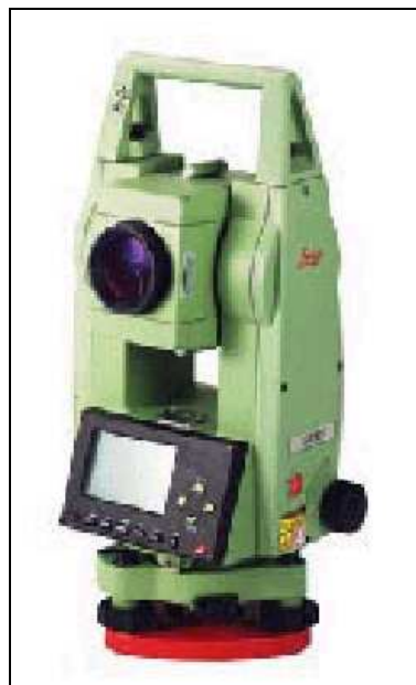
Φωτ.. 2.6: Ολοκληρωμένος γεωδαιτικός σταθμός TCR303
