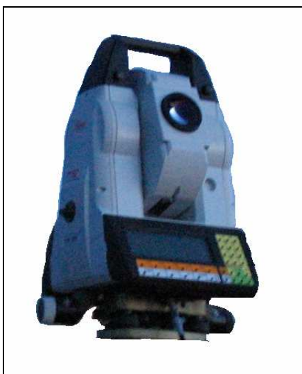
Φωτ. 2.3 : Ο ολοκληρωμένος γεωδαιτικός σταθμός Leica TDM 5000 και TDM 5005
