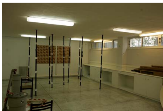
Εικόνα 6.1: Οι φωτογραφίες του πεδίου ελέγχου που χρησιμοποιήθηκαν για τη βαθμονόμηση της μηχανής
