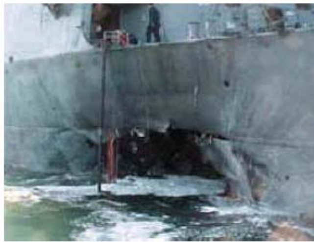
Σχήμα 9. Γενική όψη ρήγματος σε γάστρα πλοίου
