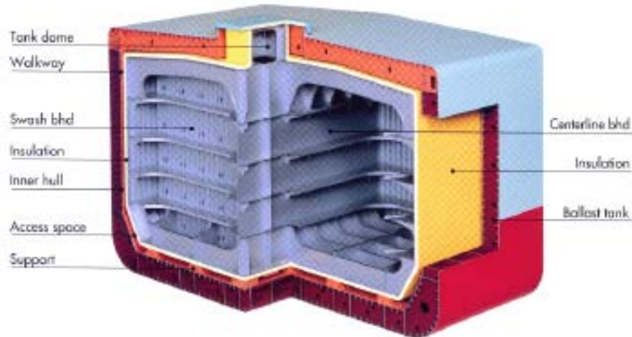
Σχήμα 5. Κατασκευαστική δομή μεμβρανικών δεξαμενών
