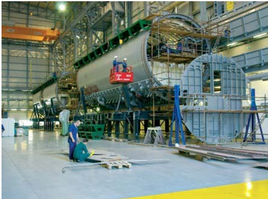
Σχήμα 7.3: Νομείς υποβρυχίου κατά τη συγκόλληση [ www.hellinic-shipyards.gr ] Figure 7.3: Submarine hull parts during the welding procedure [ www.hellinic-shipyards.gr ]
