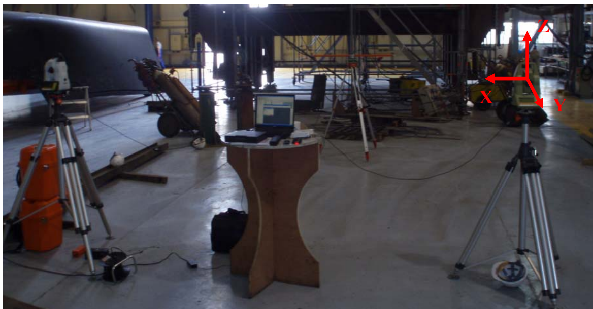
Σχήμα 7.5: Σύστημα αναφοράς καρτεσιανών συντεταγμένων όπως ορίζεται από το Axyz Figure 7.5: Cartesian Coordinates System as it is set by Axyz
