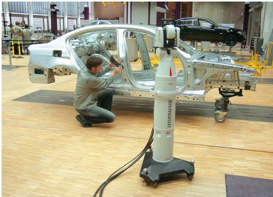
Σχήμα 5.3: Έλεγχος σκελετού αυτοκινήτου της BMW με χρήση Laser tracker συνδεδεμένου με Η/Υ εφοδιασμένο με το Axyz [ www.leica-geosystems.com ] Figure 5.3: Bmw chassis control using Laser tracker on-line with Axyz-equipped PC [ www.leica-geosystems.com ]
