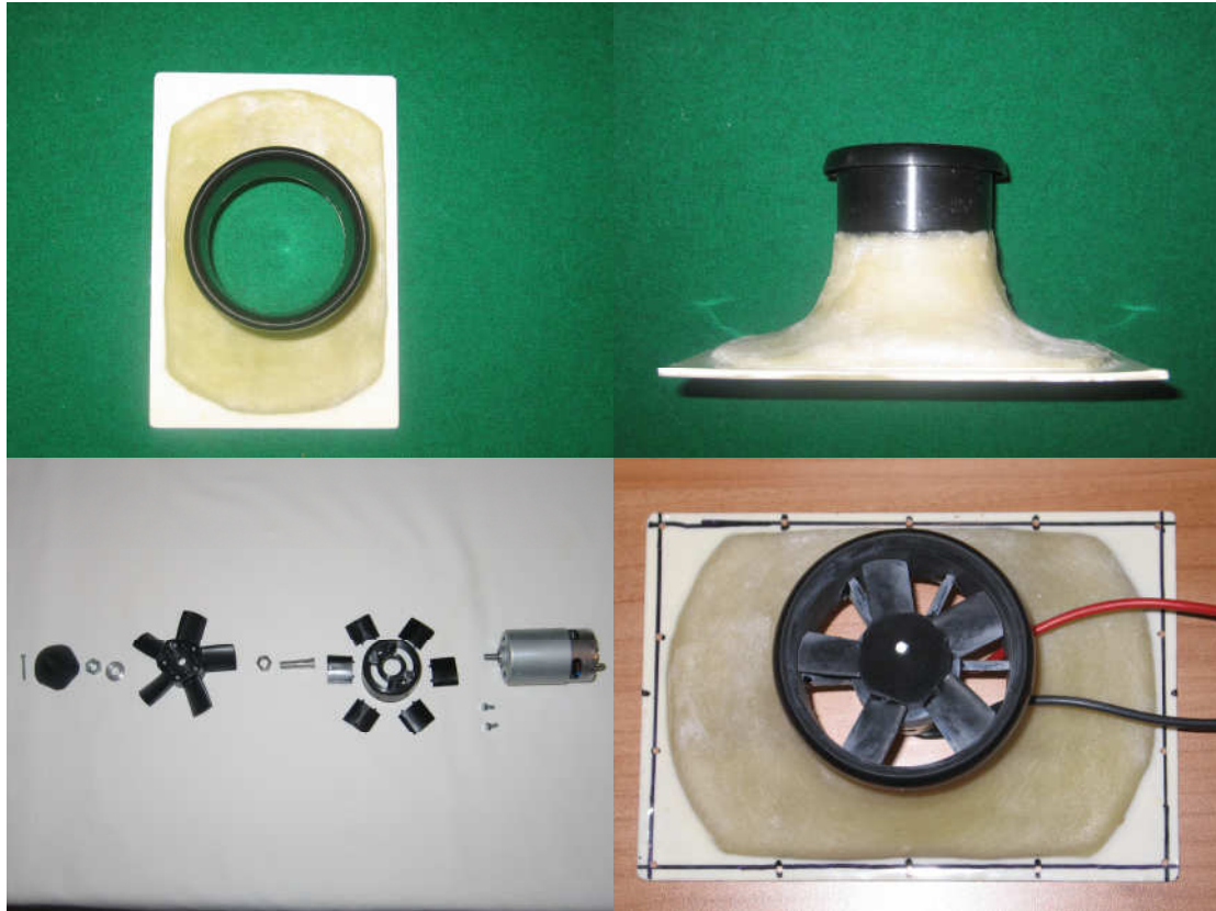
Σχήμα 2.10. Αγωγός διοχέτευσης αέρα με δακτύλιο, ηλεκτρικός κινητήρας με φτερωτές και συναρμολογημένο blower .
