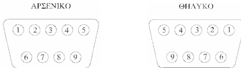
Σχήμα 4.9. Απεικόνιση των pin στο αρσενικό και θηλυκό βύσμα τύπου DB-9S.
