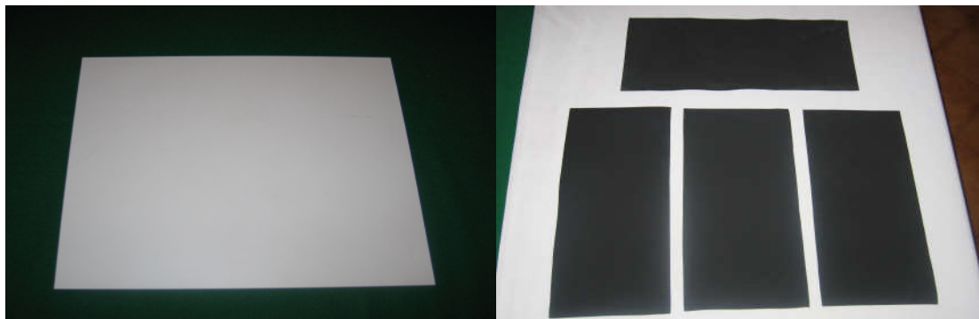
Σχήμα 2.15. Πλαστικό φύλο πάχους 1mm και αφρώδες ελαστικό υλικό.
