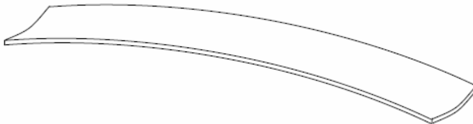
Σχήμα 2. Καμπυλότητα σε μη-συμμετρικό με διασταυρώμενες στρώσεις σύνθετο υλικό λόγω θερμικών παραμενουσών τάσεων.
