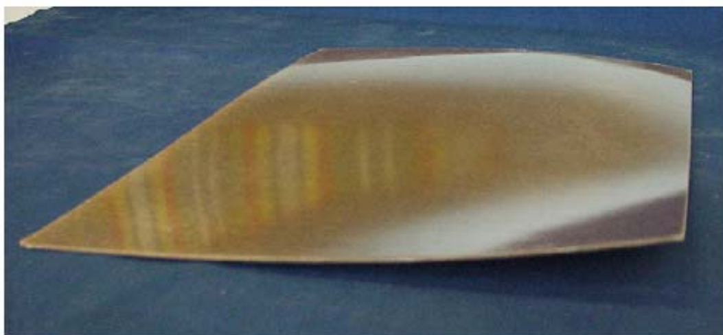
Σχήμα 18. Καμπύλωση σύνθετου υλικού ινών γυαλιού / εποξικής μήτρας λόγω μη συμμετρικής ψύξης σε πρέσσα.
