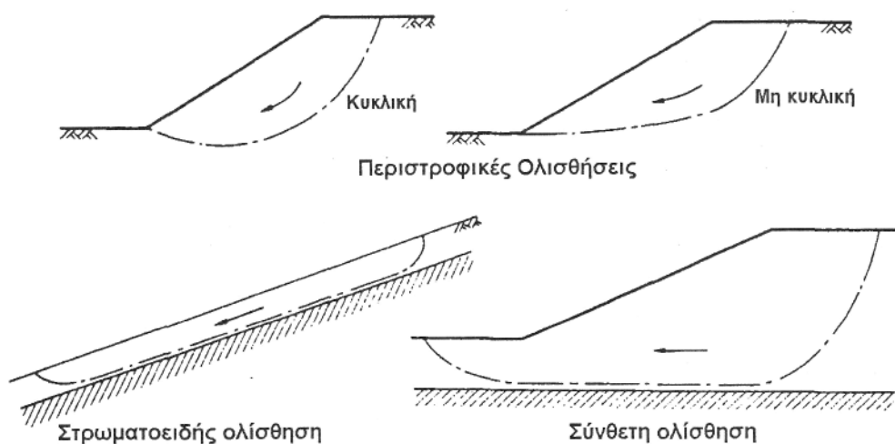
Σχήμα 1: Μορφές αστοχίας πρανούς
