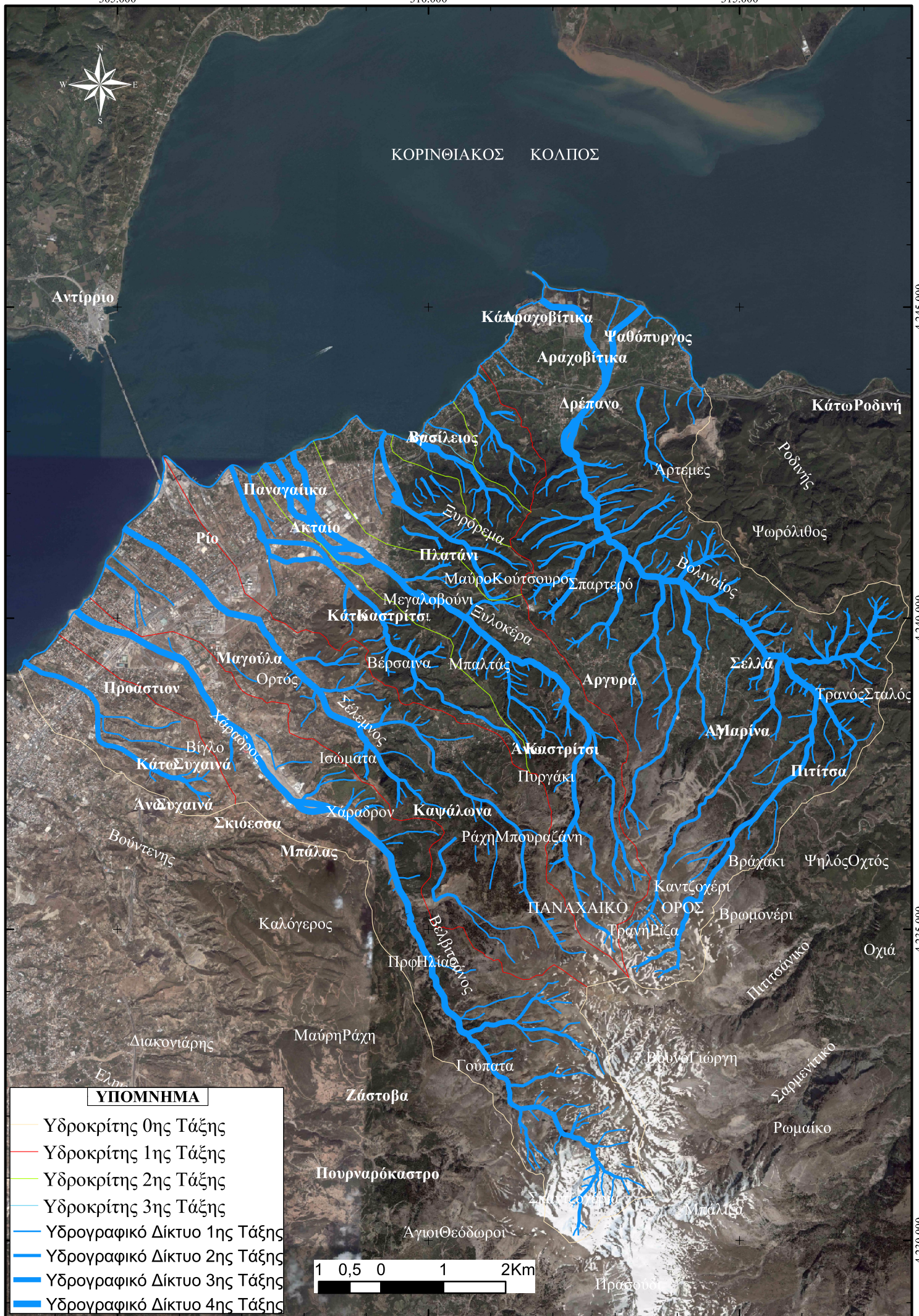
Εικόνα 27: Χάρτης Google με λεκάνες απορροής και υδρογραφικό δίκτυο
