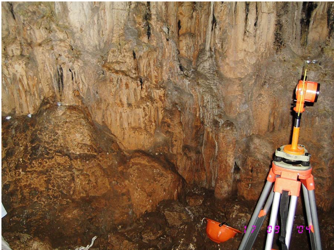
Εικόνα 3. 6: Χρήση της μεθόδου των 3 τριπόδων για τη μέτρηση των στοιχείων της όδευσης
