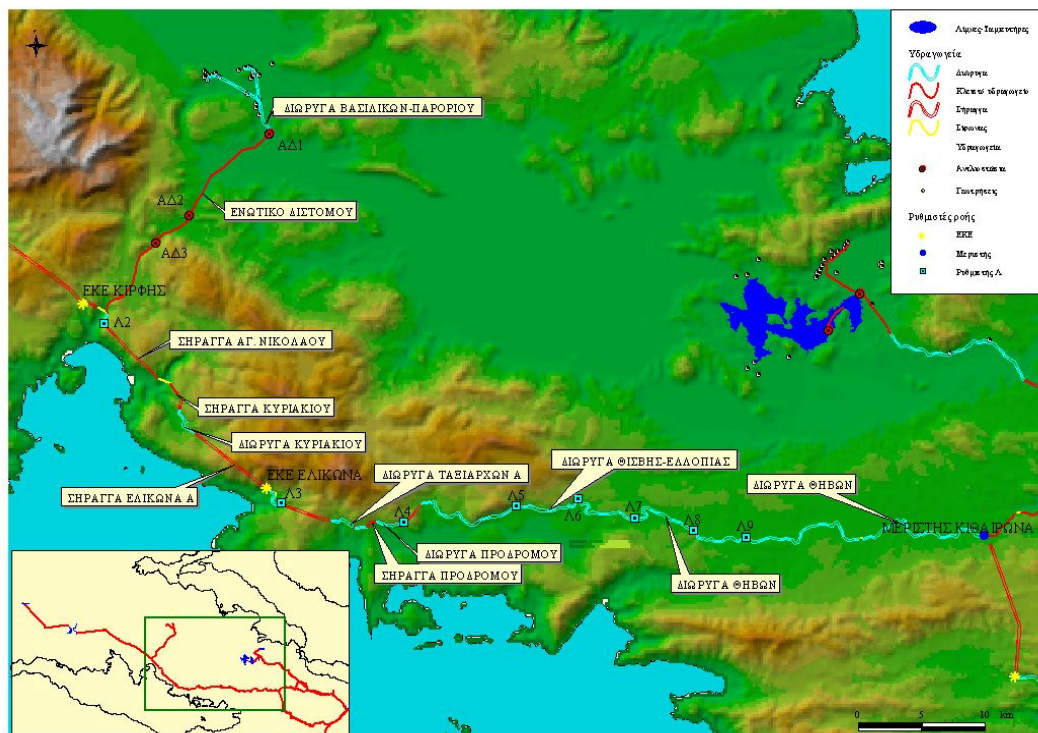
Σχήμα 4.7: Υδραγωγείο Μόρνου κατόντη ενωτικού υδραγωγείου Διστόμου
