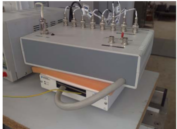
Εικόνα Α4: Δέκτης τιμών θερμοκρασίας από τους 8 θερμίστορες
