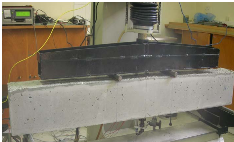
Σχήμα 2.6 Η πειραματική δοκό κατά την επιβολή της φόρτισης στην μηχανή κάμψης.
