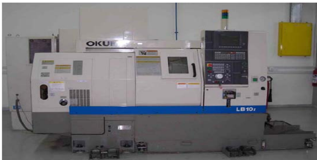
Εικόνα 3.1 Κέντρο κατεργασίας του οίκου OKUMA τύπου LB10II.
