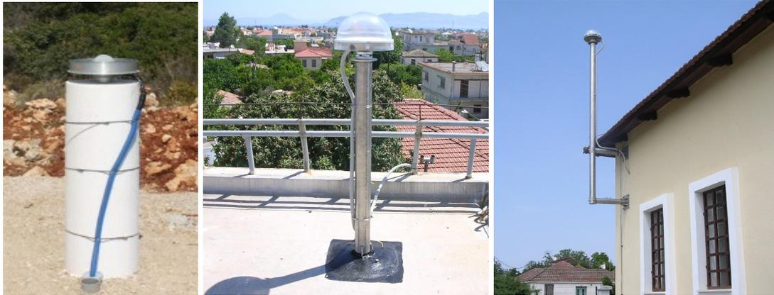
*Εικόνα 3.21: Κεραίες σταθμών αναφοράς τοποθετημένες σε βάρθρο και σε οροφή και τοίχο κτιρίου.*
