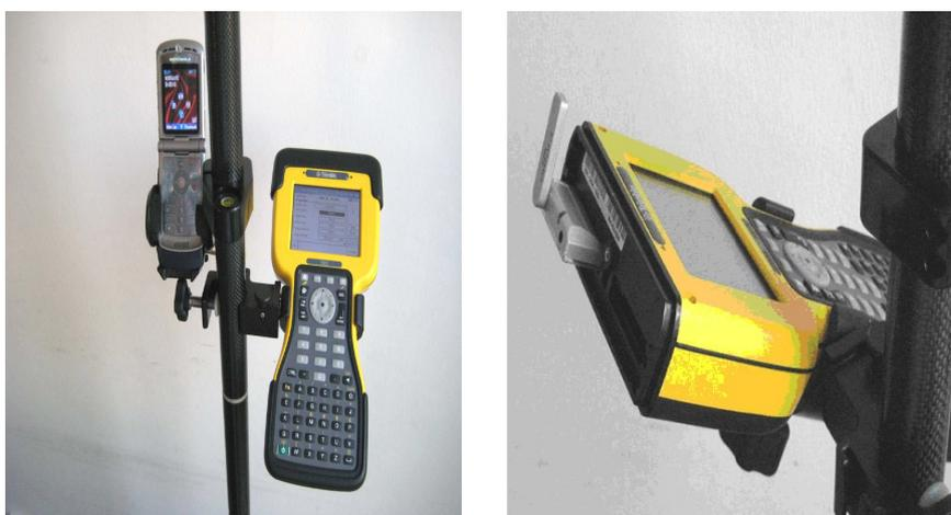
Εικόνα 3.24: Σύνδεση με το Κέντρο Ελέγχου μέσω κινητού τηλεφώνου (το χειριστήριο συνδέεται με το κινητό μέσω Bluetooth) και μέσω Compact Flash κάρτας GSM/GPRS.
