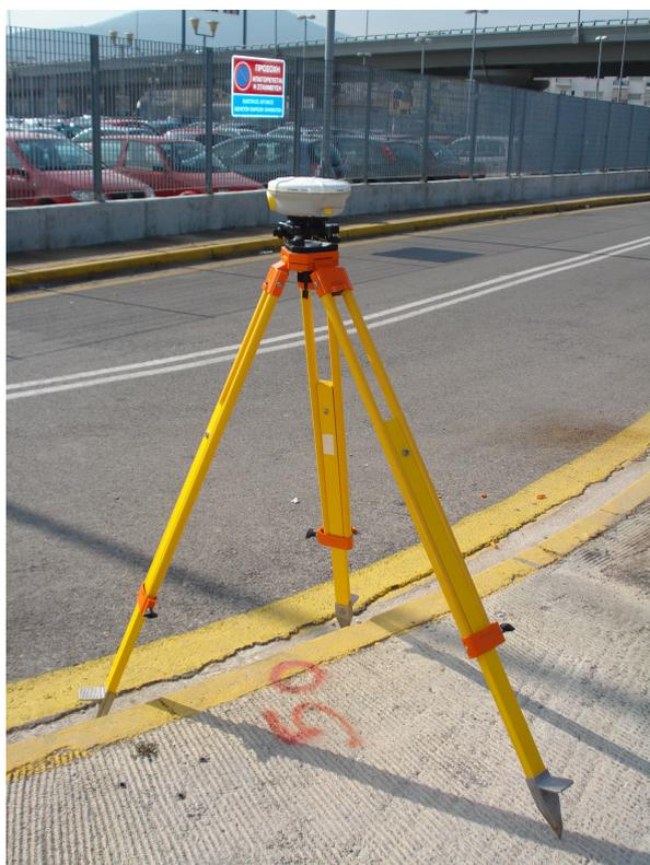
*Εικόνα 4.8: Χρήση του δέκτη “Trimble 5800” για την εκτέλεση των μετρήσεων μετεπεξεργασίας.*
