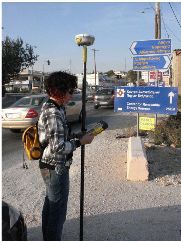
Εικόνα 4.7: Χρήση του δέκτη “Trimble R8 G.N.S.S.” με το χειριστήριο “TSC2” για την εκτέλεση των μετρήσεων πραγματικού χρόνου.
