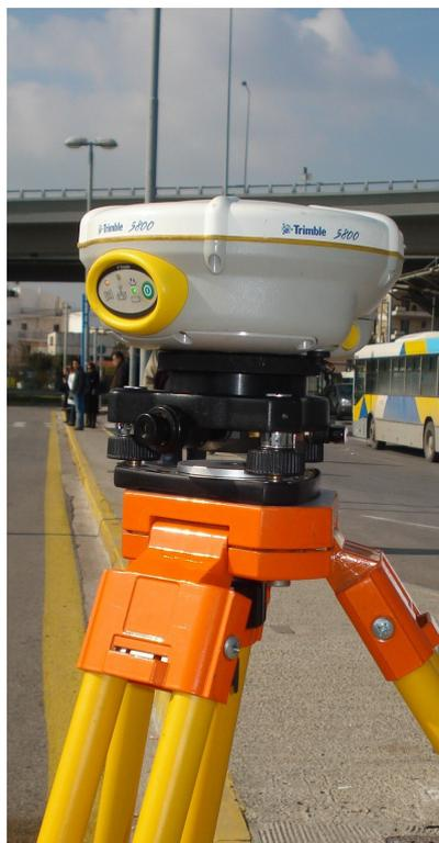
Εικόνα 4.5: Δέκτες “Trimble R8 G.N.S.S.” και “Trimble 5800”.
