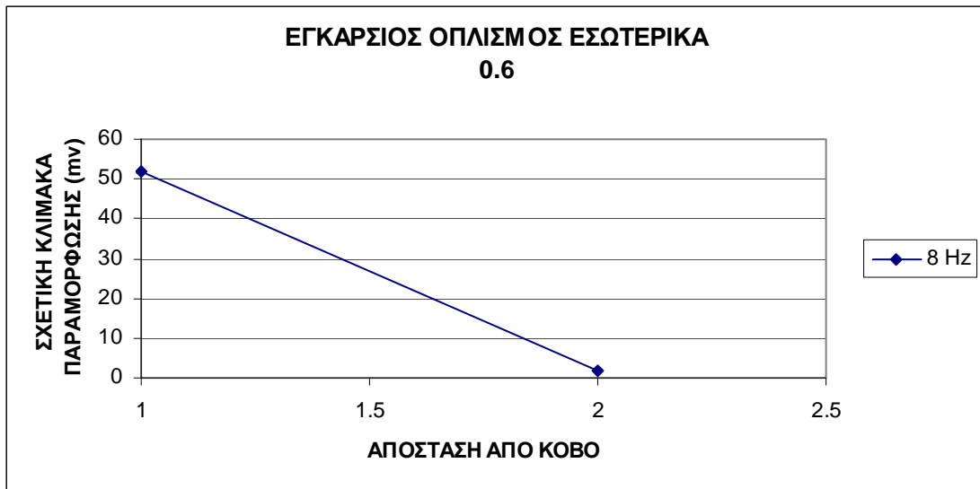
Σχήμα 4.102 Διάγραμμα σχετικής κλίμακας παραμόρφωσης για εύρος ταλάντωσης 0.6.
