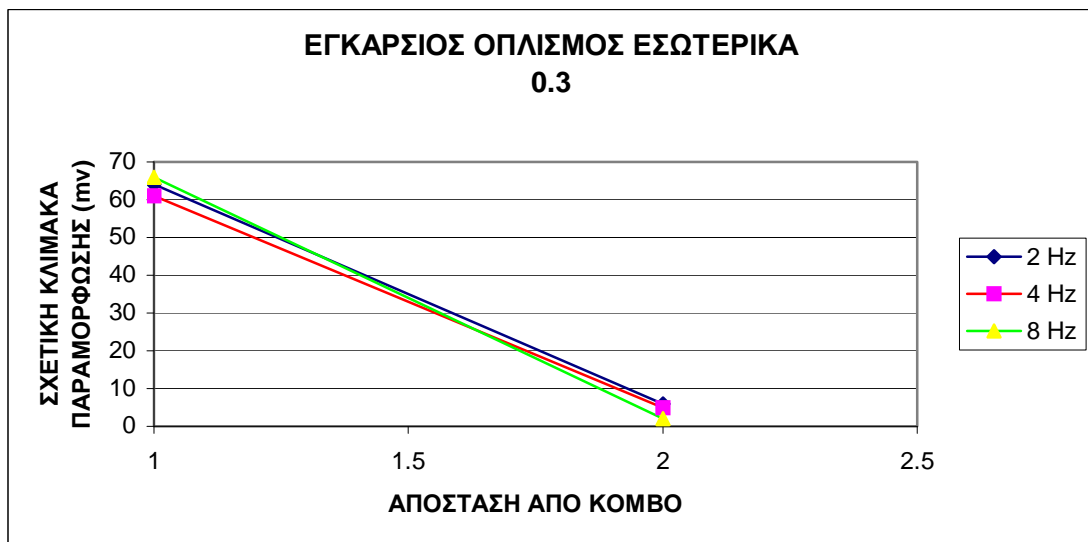
Σχήμα 4.100 Διάγραμμα σχετικής κλίμακας παραμόρφωσης για εύρος ταλάντωσης 0.3.
