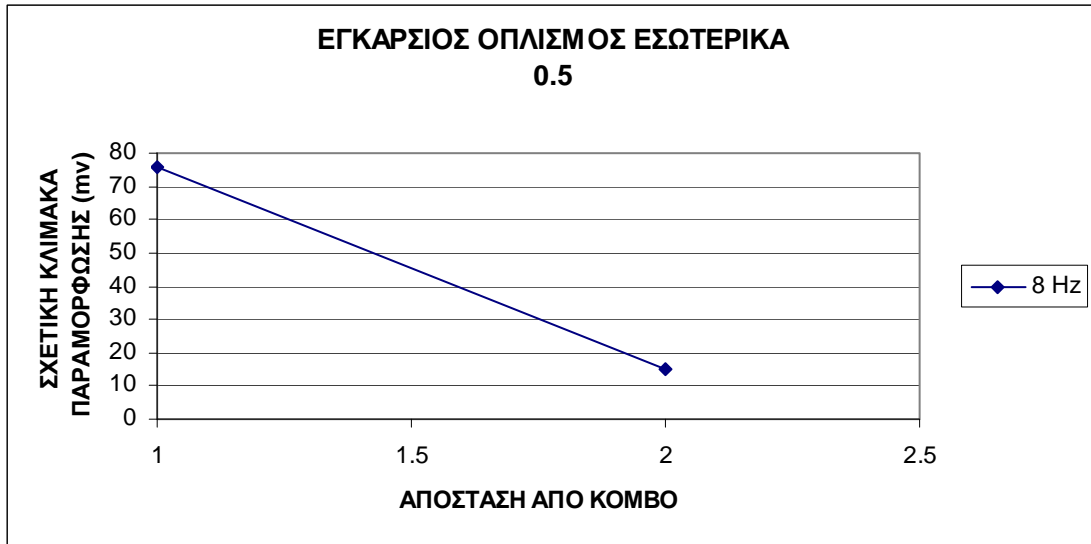
Σχήμα 4.101 Διάγραμμα σχετικής κλίμακας παραμόρφωσης για εύρος ταλάντωσης 0.5.
