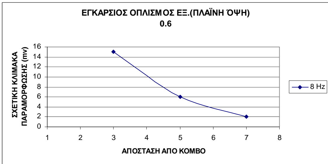
Σχήμα 4.96 Διάγραμμα σχετικής κλίμακας παραμόρφωσης για εύρος ταλάντωσης 0.6.
