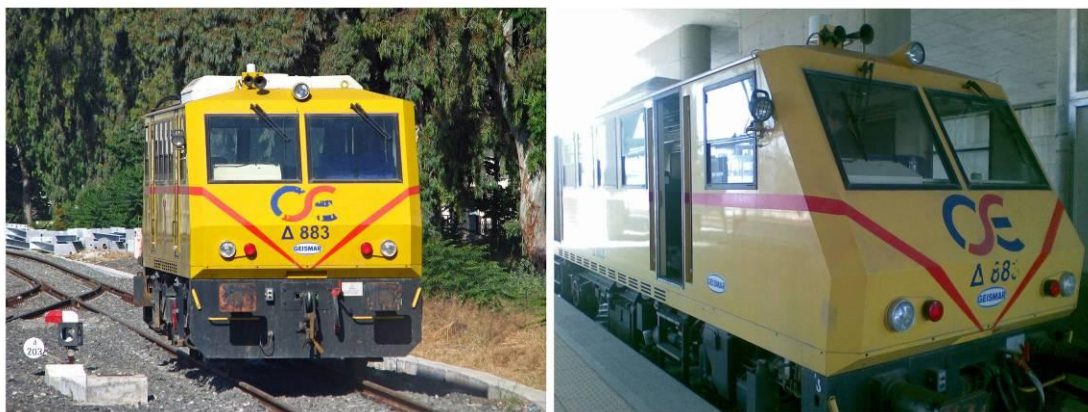
Σχ. 4.9 Εξωτερική άποψη δρεζίνας
