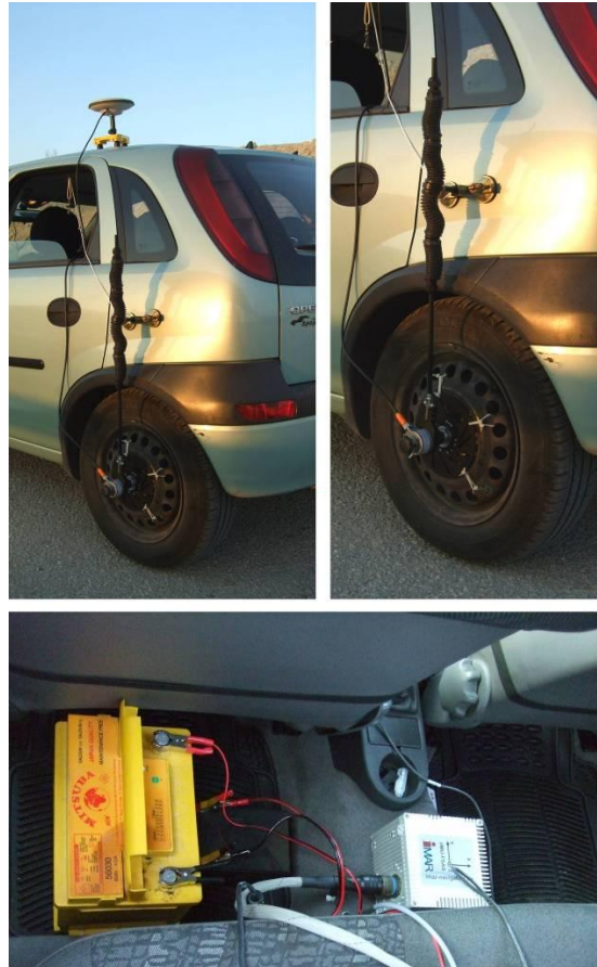
Σχ. 4.5 Προσάρτηση οδομέτρου και αδρανειακής μονάδας στο όχημα καταγραφής Fig. 4.5 Odometer and IMU installation on the recording vehicle
