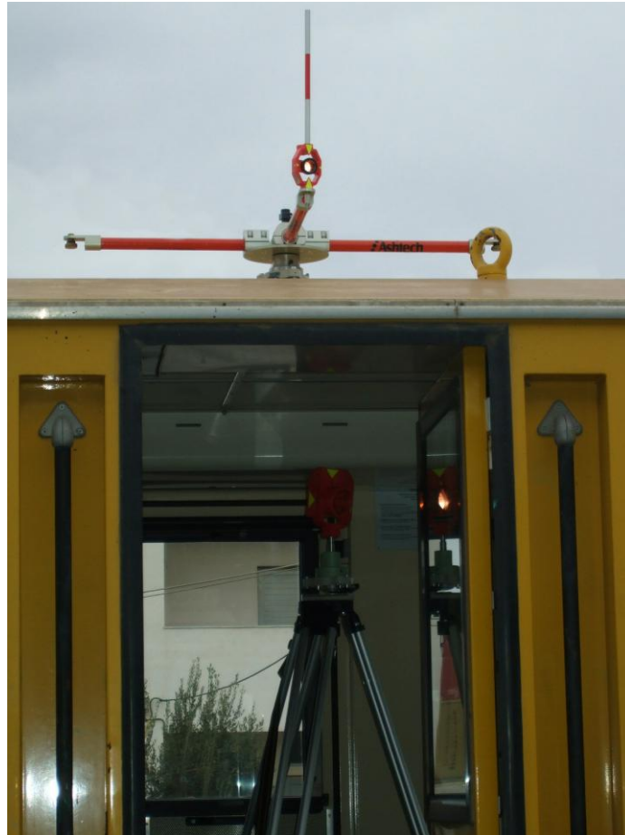
Σχ. 5.6 Τοποθέτηση κατάφωτου για μέτρηση εκκεντροτήτων στη κεραία GPS
