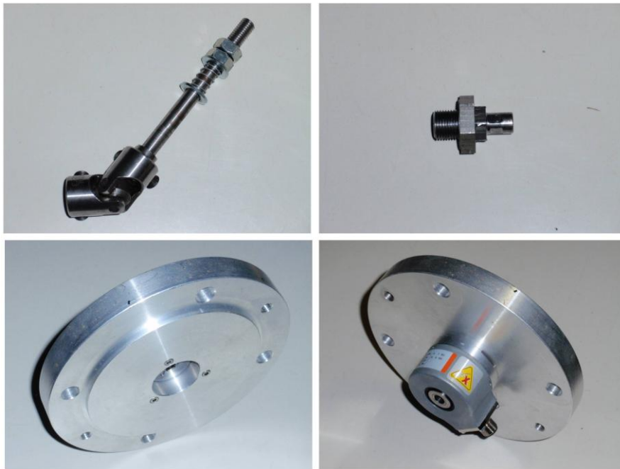
Σχ. 4.11 Μέρη μετατροπής προσάρτησης οδομέτρου Fig. 4.11 Parts for odometer attachment modification
