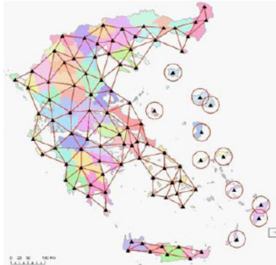
Εικόνα 3- 7: Οι 98 Σταθμοί αναφοράς HEPOS (Πηγή: Δ. Μάστορης, Περιγραφή του HEPOS, 2008)
