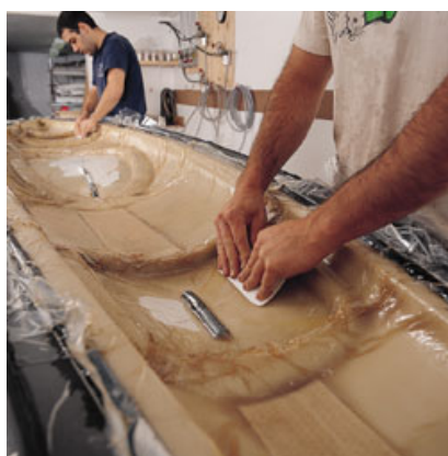
Σχήμα 1.4: Μορφοποίηση με πίεση (vacuum bag moulding)
