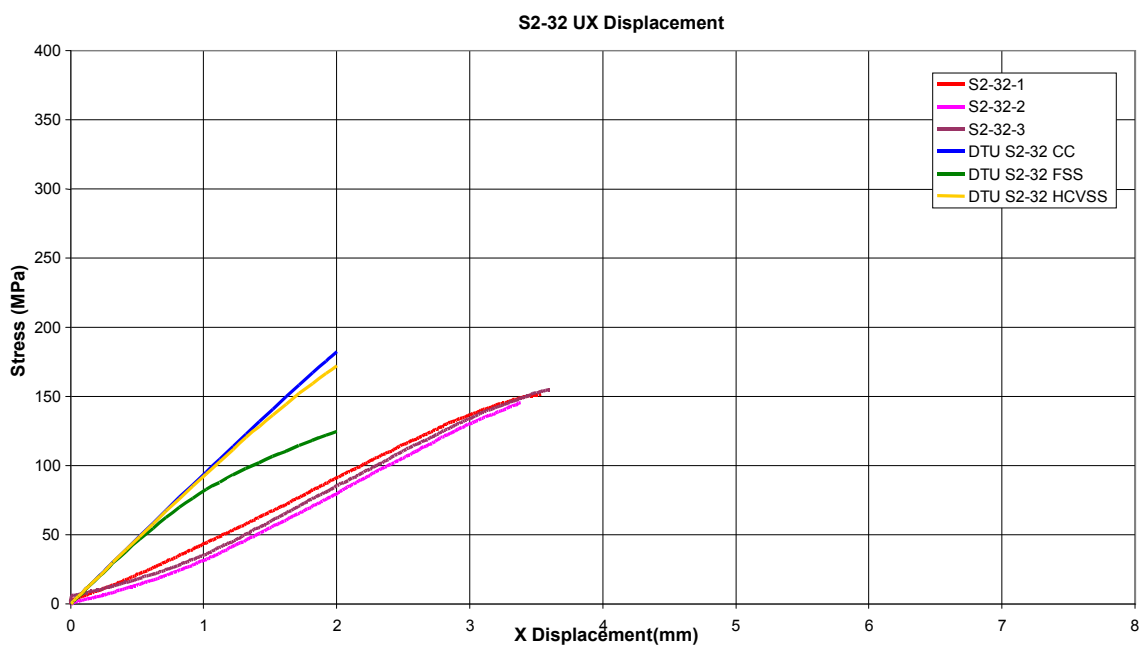
Σχήμα 4.14 : Μετατόπιση Ux, πλάκες με μικρή γεωμετρική ατέλεια
