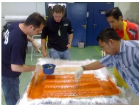
Σχήμα 1.3 : Μορφοποίηση με απλή επαφή
