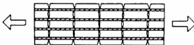
Σχήμα 1.8: Ρηγμάτωση ρητίνης πριν τη θραύση των ινών
