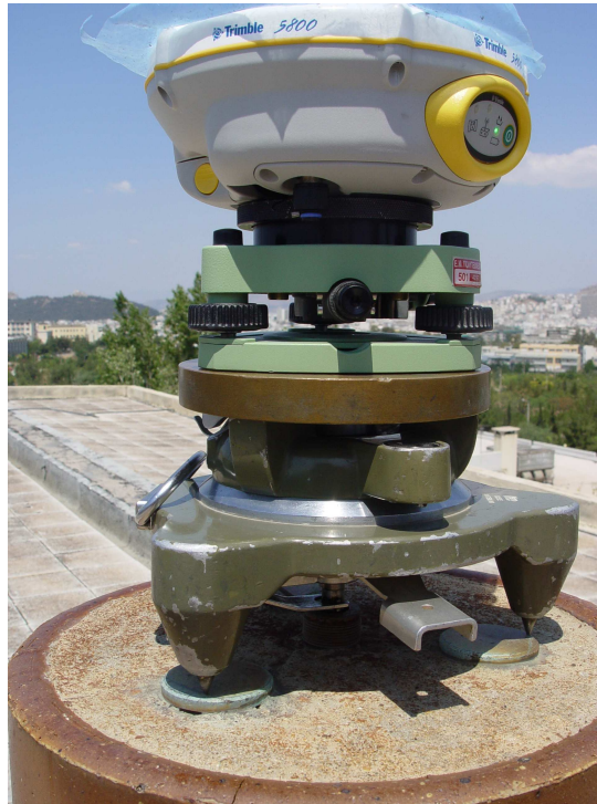
Φωτογραφία 2.2: Σύστημα δέκτη GPS Trimble 5800 - τρικοχλίου - βάσης εξαναγκασμένης κέντρωσης
