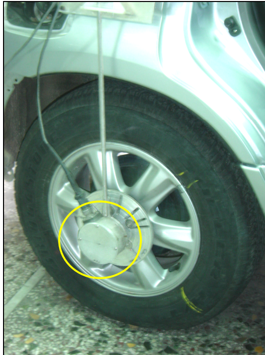
Σχήμα 5.4: Διάταξη ψηφιακού οδομέτρου στο όχημα
